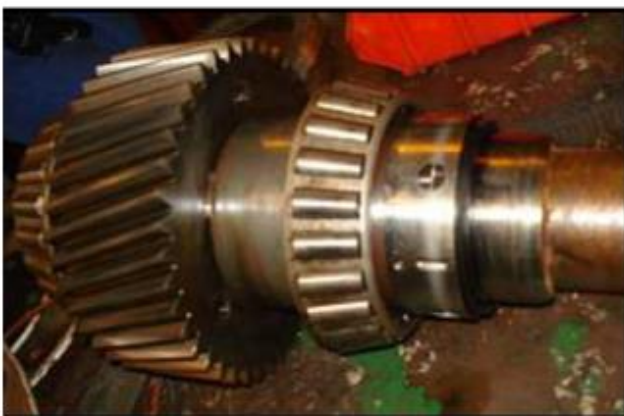
✓ Excesiva vibración y ruptura de rodamientos
