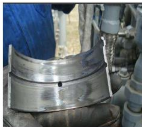
✓ Excesiva vibración y ruptura de rodamientos
