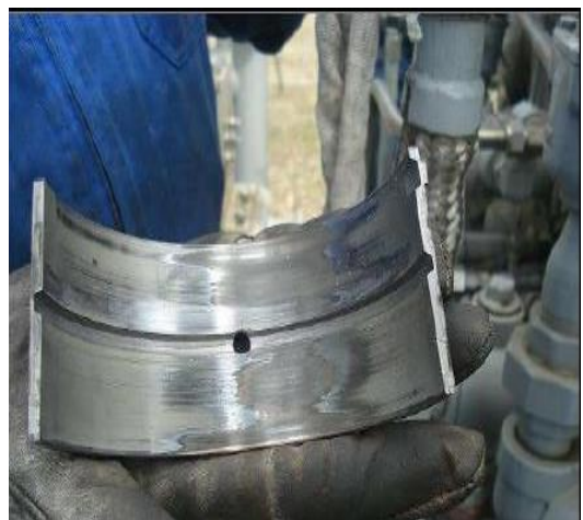
✓ Excesiva vibración y ruptura de rodamientos
