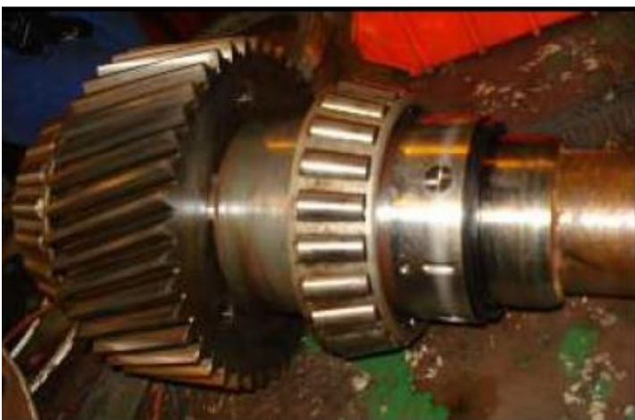
✓ Excesiva vibración y ruptura de rodamientos
