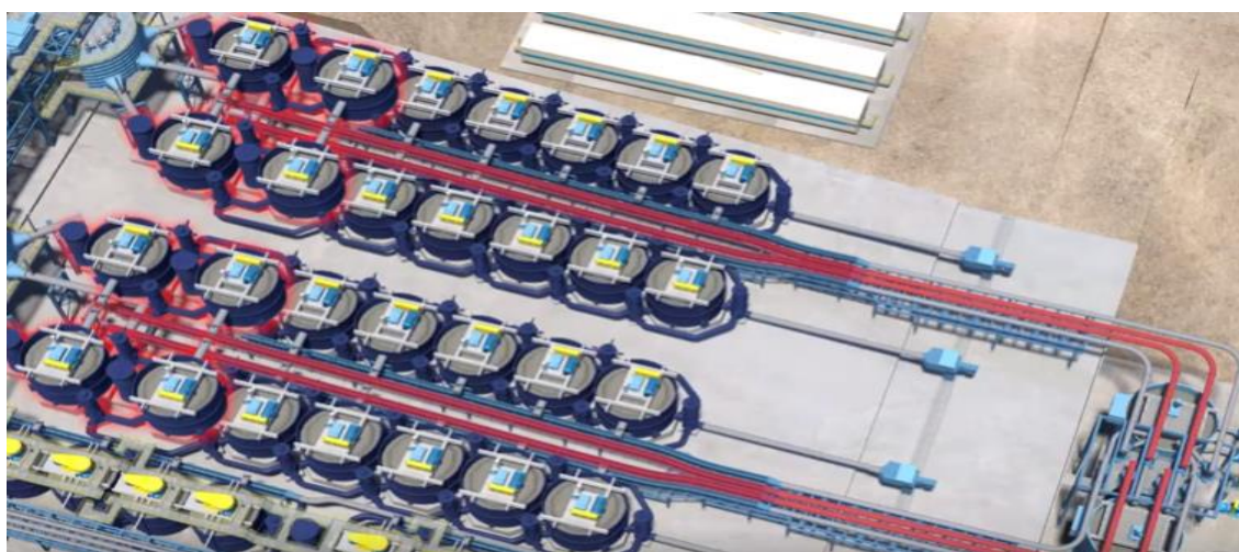
Figura 24. Equipos críticos del área de flotación
