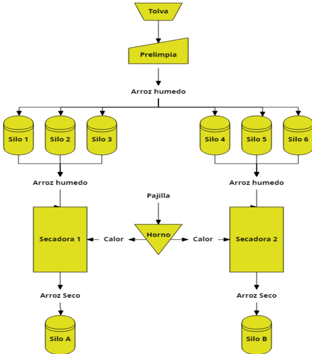
Figura 4: Diagrama de Flujo, área Pilado.
