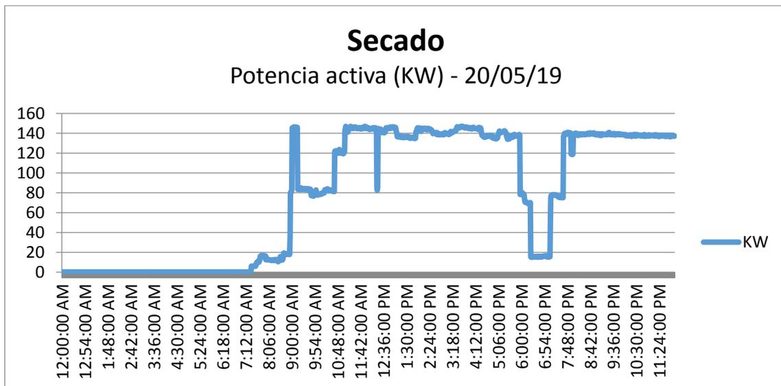
Se observa que la máxima demanda en el área de secado, se llevó a cabo a las 11:07 a.m., el cual el sistema requería 147 KW.
