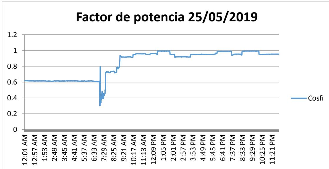
En el siguiente cuadro es la representación del registro de un día de producción en el cual se puede notar que el factor de potencia cuando no hay cargas conectadas a la red (ningún motor encendido) es de 0.61 inductivo, cuando las labores inician aproximadamente a las 7 de la mañana el factor se eleva hasta 0.8 inductivo y finalmente cuando inicia la producción a las 8 de la mañana el factor de potencia se encuentra entre 0.95 y 0.99 durante el proceso productivo.
