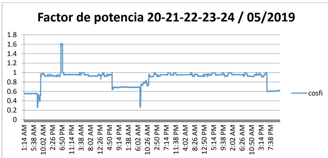
En esta figura nos muestra las medidas de 5 días de producción, en cual se puede observar que el factor de potencia oscila entre 0.95 y 1 en las horas
