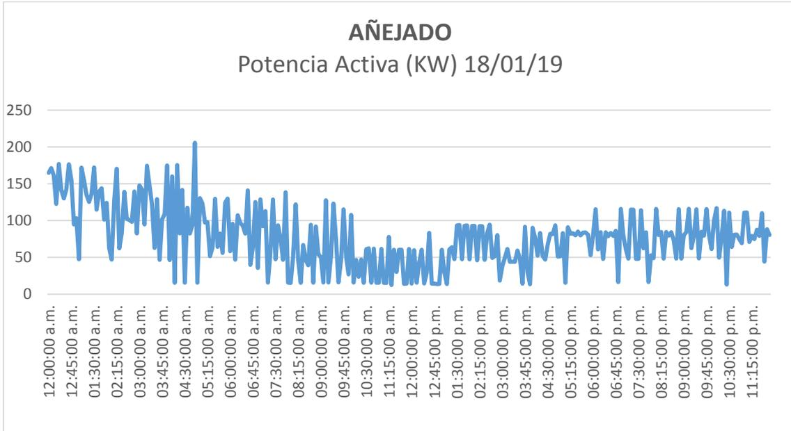
Se observa que la máxima demanda en el área de añejado se llevó acabo a las 4:50 a.m. de la mañana, en el cual el sistema requería 205.00 KW.
