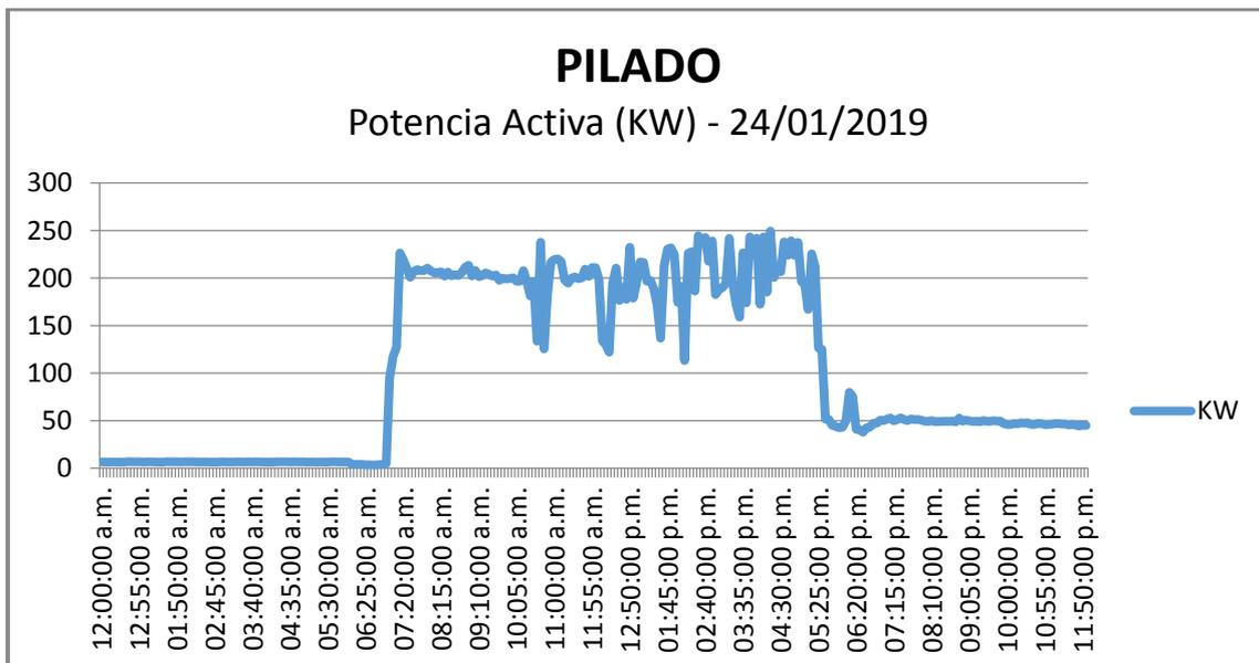
Se observa que la máxima demanda en el área de pilado se llevó a cabo a las 4:14 p.m., en el cual el sistema requería 249.43 KW.
