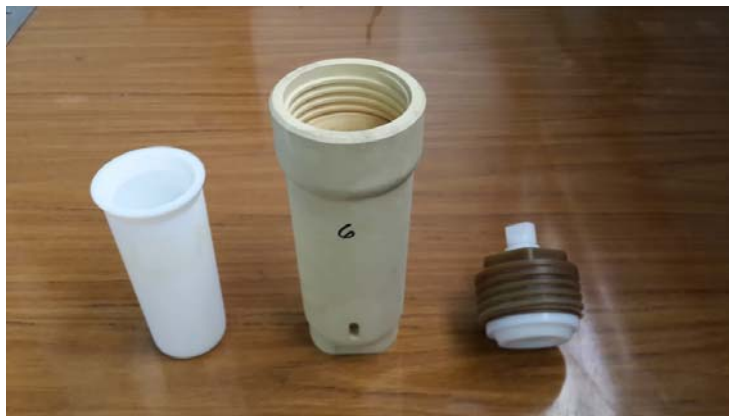
Vessels y porta vessels utilizados para la digestión de las muestras. Horno de microondas
