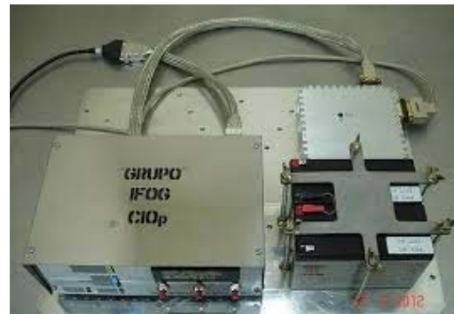
Giróscopos láser e interrogador fabricados en el CIOp
