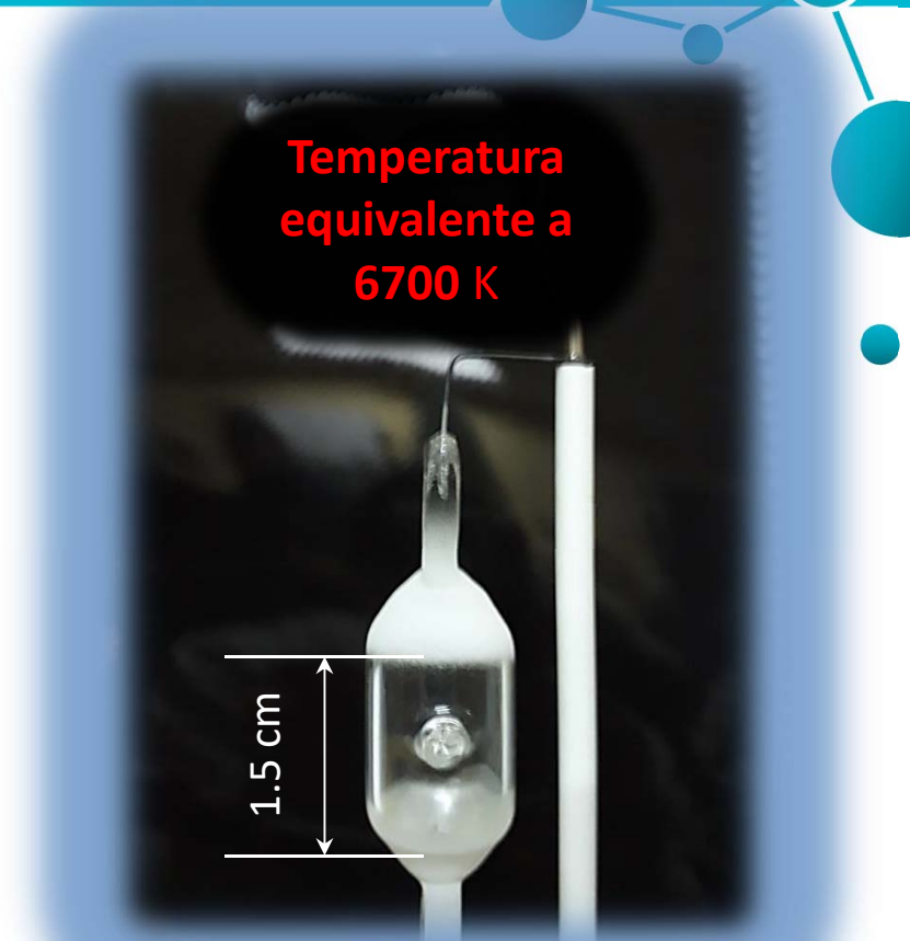
Lámpara de descarga de Hg de alta presión halogenado. Potencia nominal 250 W (a 220V). Densidad de energía UV-C \sim 1 \text{ W} \cdot \text{s/m}^2
