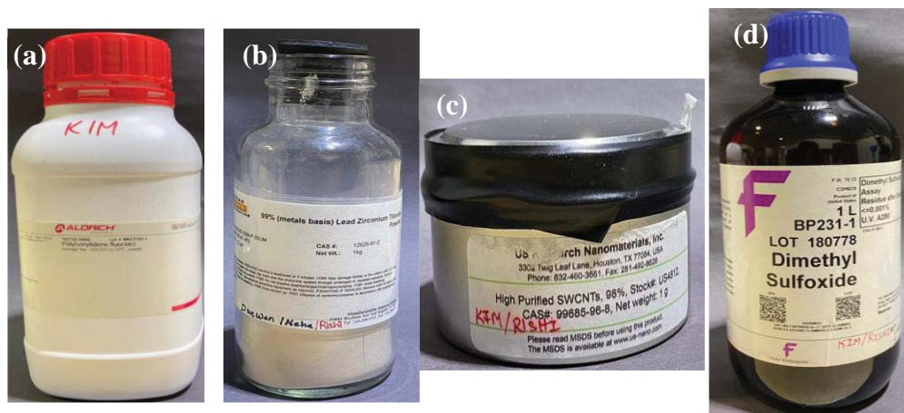
Figure 2.1 Materials used, (a) PVDF, (b) PZT, (c) SWCNTs and (d) DMSO.
