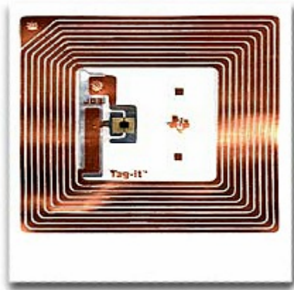
Figure 1. RFID TAG (From: rfid-informationen.de/info/rfid-tag.jpg , 2006)
