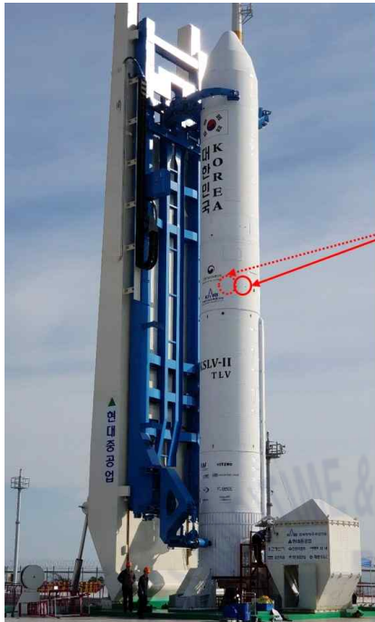
그림 2.7 누리호 시험발사체 탑재 송신 안테나 위치 Fig. 2.7 On-board Tx. antenna position of NURI TLV
