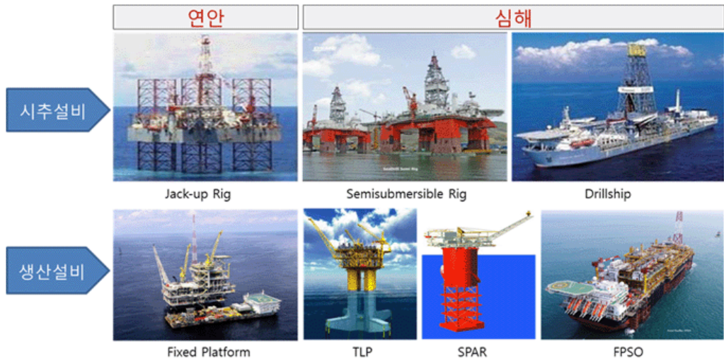
부록그림 8 offshore oil & Gas 시추설비와 생산설비
