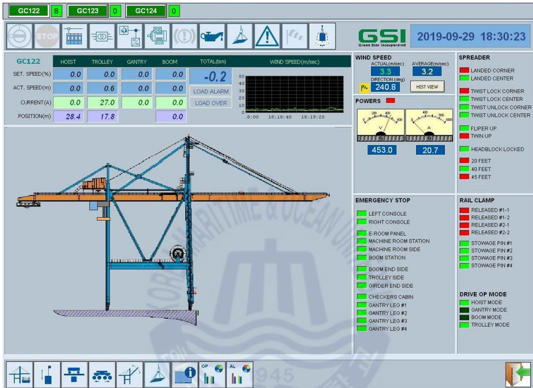
[그림 2.7] H' 사 STS 크레인 CMS(Crane Monitoring System)
