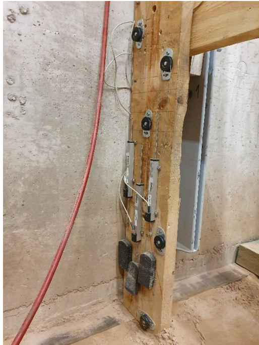
Joonis 3.12. Mudelkiilvaia vertikaal- ja horisontaalsiirete mõõtmise siirdeandurid.
