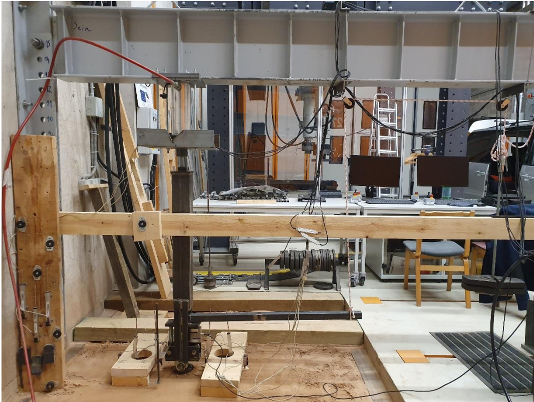
Joonis 3.16. Mudelkiilvaial vertikaalkoormuse ja momendi koosmõju rakendamine.
