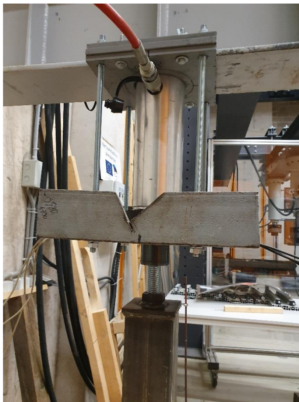
Joonis 3.11. Paigaldatud hüdrocilinder Lukas LZM 25/200 vertikaalkoormuse rakendamiseks reguleeritavale tugipostile.
