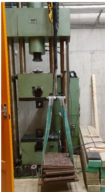
Joonis 3.14. Mudelkiilvaiale vertikaalkoormust hoidev hüdrocilinder 25/40
