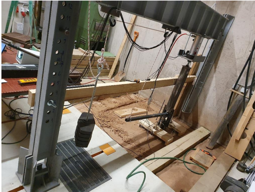
Joonis 3.15. Mudelkiilvaiale momendi tekitamise mehhanism.
