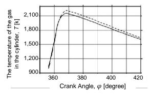
**Figure 4.** Temperature change in engine cylinder depending on crankshaft rotation angle. Temperatuuri T muutumise dünaamika mootori silindris olenevalt väntvõlli pöördenurgast  $\varphi$ : — diesel fuel;  $\blacksquare$   $\blacksquare$  – biodiesel fuel.
