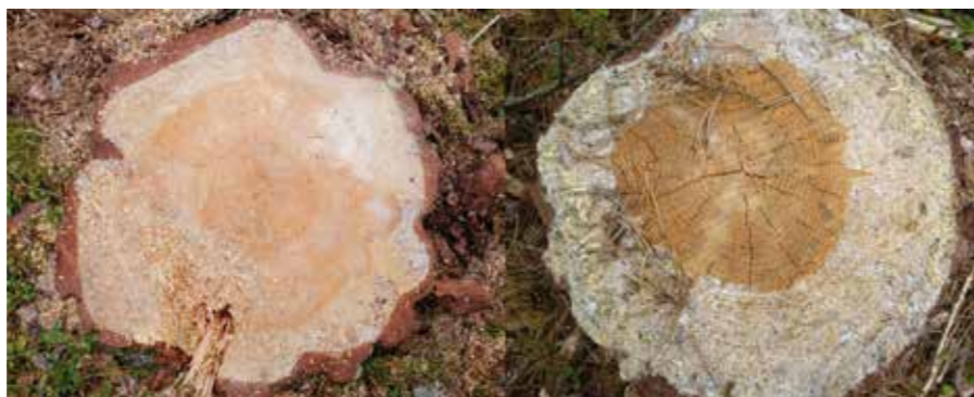
Joonis 12 Püsimetsas kasvanud mänd (vasakul) on ühtlasema süüga ja suurema lülipuidu osakaaluga kui lagedal kasvanud, millel on laiade aastarõngastega keskosa.
