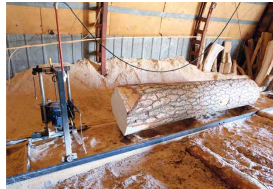
Joonis 53 Püsimeetsas (O13) kasvanud tiheda ühtlase puiduga männi jämevalk on saematerjali lõikamiseks valmis seatud. Ots on võõbatud, et puit kuivaks ühtlaselt ja lõhenemata.
