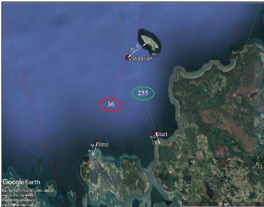
Joonis 2.2. Satelliitlõimeetria andmete valideerimiseks planeeritud marsruut Läänemeres ning punktide kaugused lähimast maismaast. Punasega on tähistatud Sentinel-3A ülelennu trajektoor ning rohelisega Sentinel-3B trajektoor, ühikud kilomeetrites.
