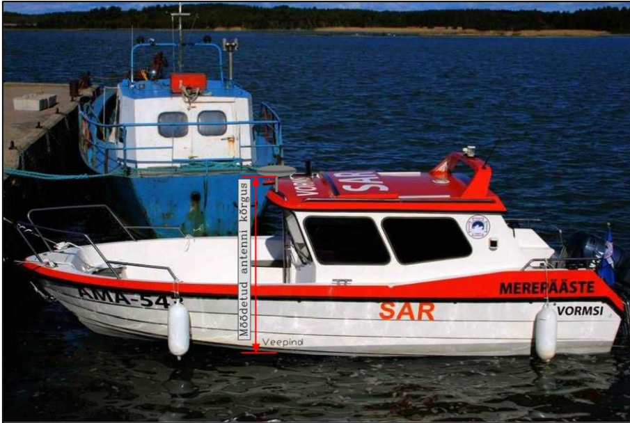
Joonis 2.9. Väikelaevale kinnitatud antenni kõrguse mõõtmist illustreeriv joonis. (Postimees/Scanpix põhjal)
