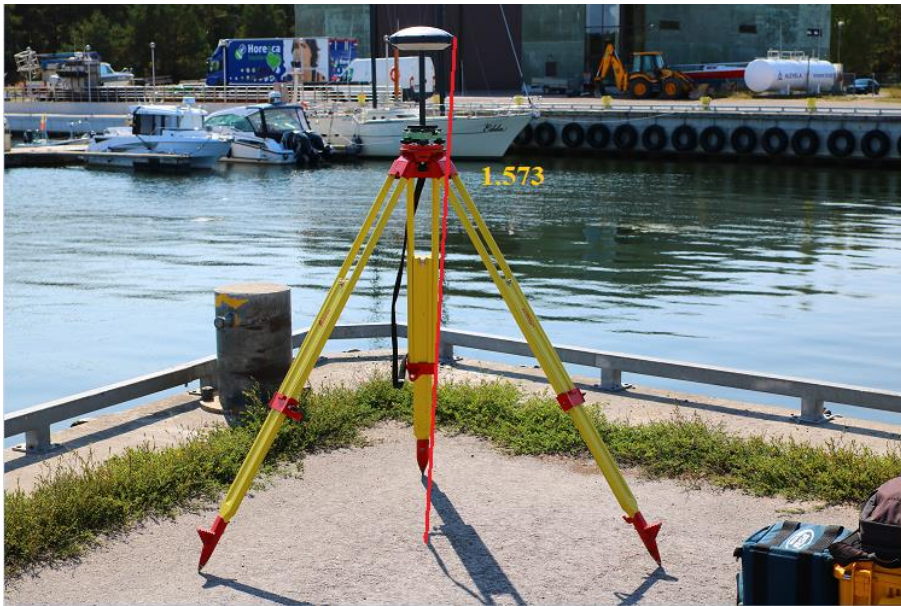
Joonis 2.3. Dirhami sadama kaile paigaldatud GNSS baasjaam Spectra Precision SP60. (Erakogu)
