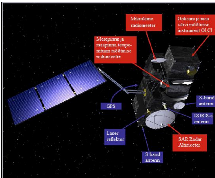
Joonis 1.9. Sentinel-3 satelliitmissiooni satelliitide pardal olevad instrumendid. (ESAh, (n.d.) põhjal)
