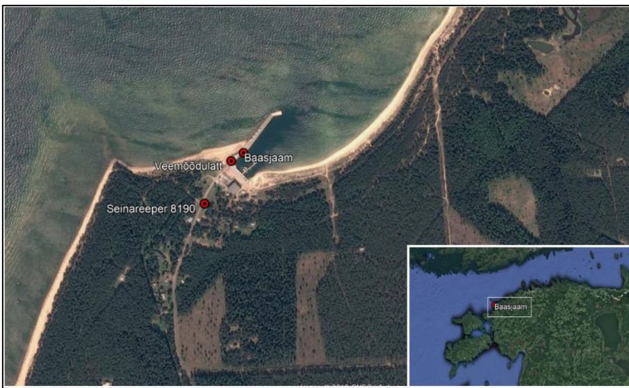
Joonis 2.6. GNSS baasjaama, seinareeperi ja veemõõdulati asukoht Dirhami sadamas.
