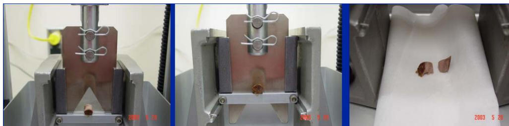
Joonis 1. Teimi lõiketugevuse määramine WB meetodil. Allikas: [2]
