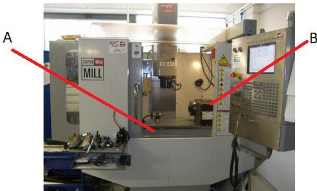
Joonis 1. A- Haas SuperMinimill S MINImill HE. B- Pöördlaud HRT 160 Figure 1. A- Haas SuperMinimill S MINImill HE. B- Rotary table HRT 160
