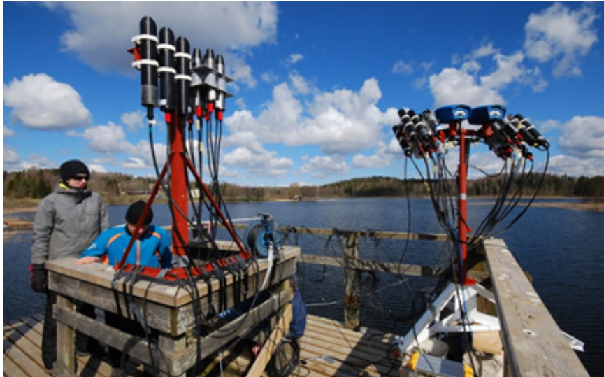
Joonis 10. Kõik kirkuse ja kiiritustiheduse sensorid olid LCE-2 välimõõtmistel paigutatud spetsiaalsetesse raamidesse, et tagada neile kindel asend ja suunata kõik mõõteriistad samale objektile. Vasakpoolne raam – kiiritustiheduse sensorid, parempoolne raam – kirkuse sensorid.
