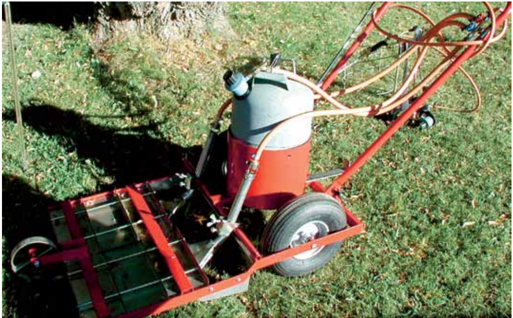
Foto 16. Thermec leegitaja tuulekaitseplekiga
