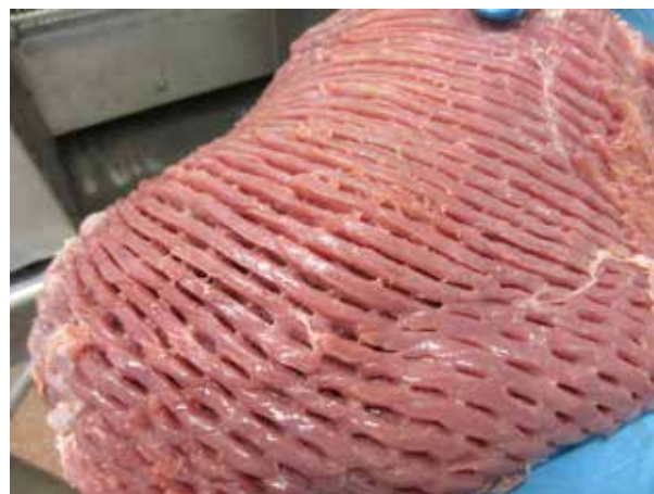
Lihalõigud lastakse läbi löikerullidega varustatud tenderisaatori.
