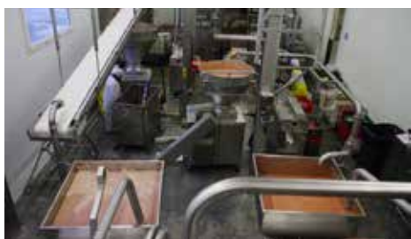
Viinerite toomisliin "Alkar" (USA). Liini tootlikus on 3500 kg/h
