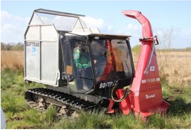
Joonis 2.14. Pilliroolõikur Loglogic Softrak (foto: Ü. Kask)
