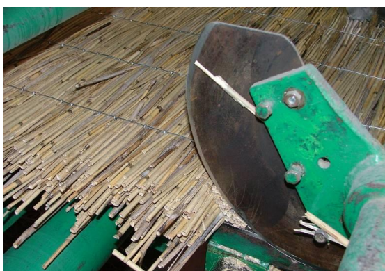
Joonis 3.50. Berger plaadi servade lõikamine (foto: M. Miljan)
