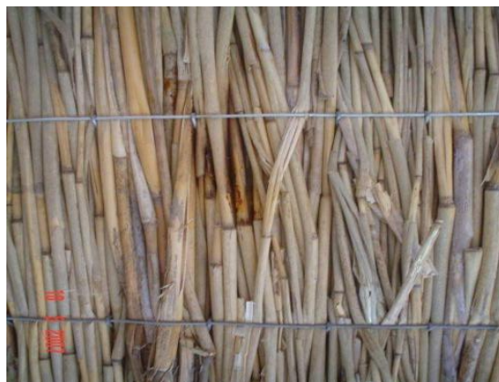
Joonis 3.38. Katsekeha 1 tagakülg pärast 15 minutit kestnud katset (foto: K. Kuus)
