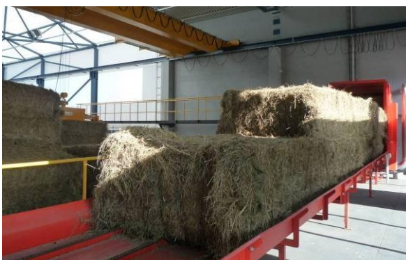
Joonis 6.6. Heina ja pilliroo lintransportöör (vasakul) ja Danstokeri biomassi katel (paremal) Lihula katlamajas (foto: Ü. Kask)
