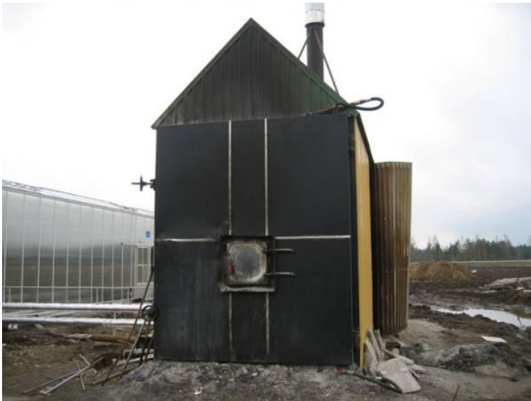
Joonis 6.4. Katel heina-/põhupallide ja -pakkide põletamiseks (foto Ü. Kask)
