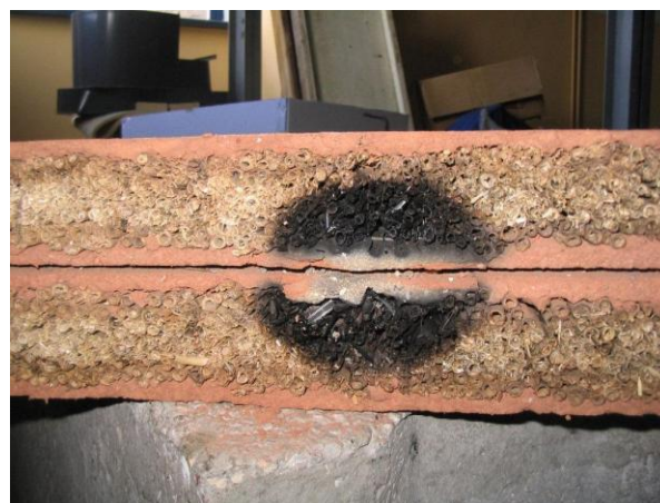
Joonis 3.40. Kahelt poolt krohvitud katsekeha ristlõige (foto: K. Kuus)
