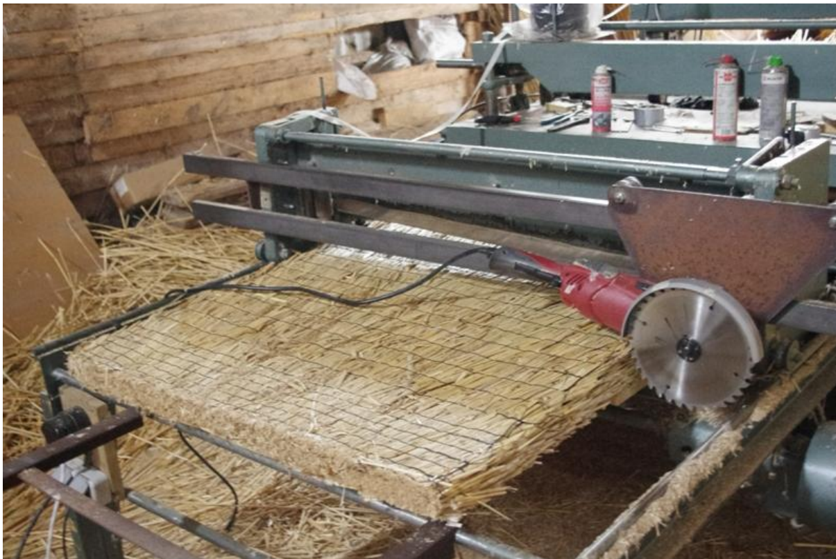
Joonis 3.51. Hiinas toodetud rooplaatide tegemise masin. Näha on tihedamalt seotud ots ja plaadi lõikamiseks mõeldud ketassaag (foto: M. Miljan)
