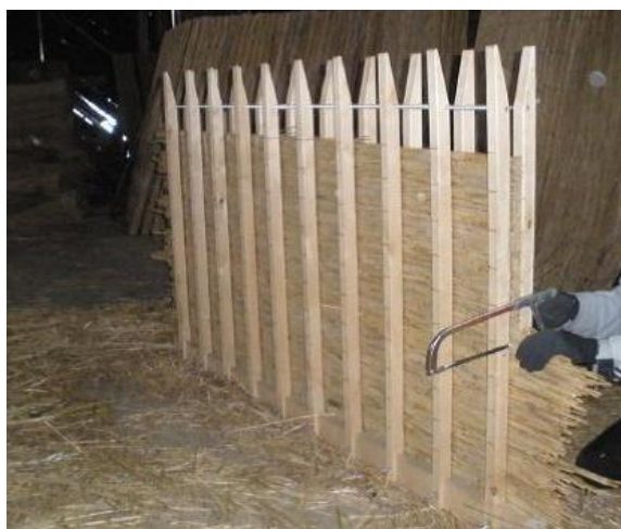
Joonis 3.48. Sidumisraam rooplaatide ja -mattide valmistamiseks käsitsi (fotod: vasemal M. Miljan ja paremal S. Sooster)
