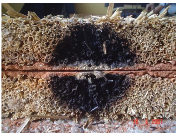
Joonis 3.39. Ühelt poolt krohvitud katsekeha ristlõige (foto: K. Kuus)
