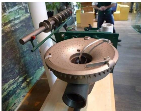
Joonis 6.7. Ringpõleti (vasakul) ja KWB Multifire katel (paremal) (fotod: Ü. Kask)
