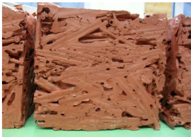
Joonis 5.8. Savist kergplokkide valmistamiseks kasutatud materjalid alates vasakult: roohake, linaluu, hõövlilaast ja savi (fotod: K. Akermann)
