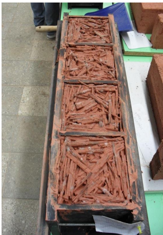
Joonis 5.9. Pilliroo-savi kergplokkide valmistamine (fotod: K. Karja)
