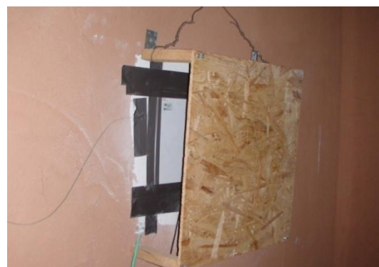
Joonis 5.5. Seina läbivat soojusvoogu mõõtev varjestatud soojusvooplaat (foto: M-J. Miljan)
