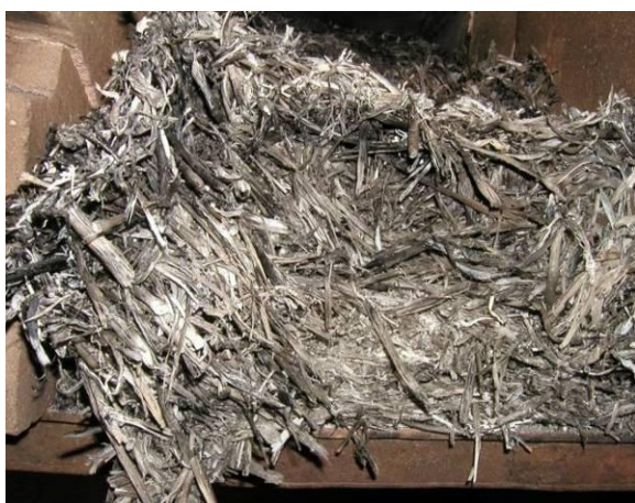
Joonis 6.9. Pilliroo jääk (tuhk) pärast katsepõletamist (vasakul) ja pelletipõletit BioLine 25 põlemisjääd (paremal) (fotod: Ü. Kask)
