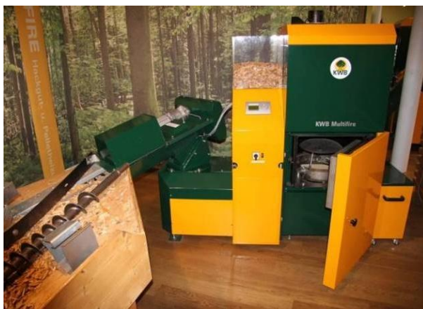
Joonis 6.7. Ringpõleti (vasakul) ja KWB Multifire katel (paremal) (fotod: Ü. Kask)
