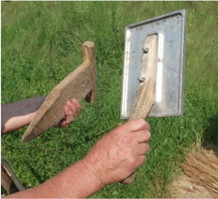
Joonis 3.1. Puidust kiil tihedate rookõrte vahele sidumistraadi jaoks ruumi tegemiseks ja metallist käpp (foto: J. Miljan)
