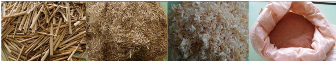
Joonis 5.8. Savist kergplokkide valmistamiseks kasutatud materjalid alates vasakult: roohake, linaluu, hõövlilaast ja savi (fotod: K. Akermann)
