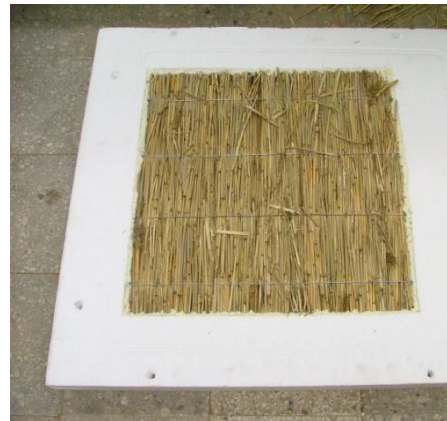
Joonis 5.2. Pillirooplaad katseelemendis (foto: J. Miljan)
