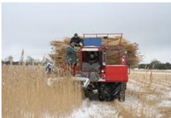
Joonis 2.2. Rookombain Seiga (foto: Ü. Kask)
