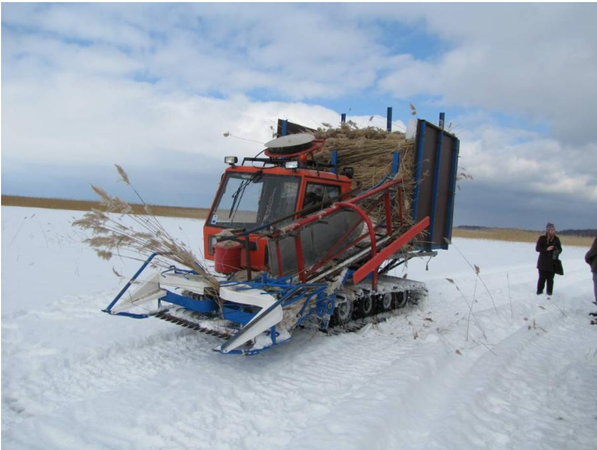
Joonis 2.5. OÜ Järveroog rookombain rajatraktorile Paana monteeritud BCS heedriga (foto: K. Akermann)
