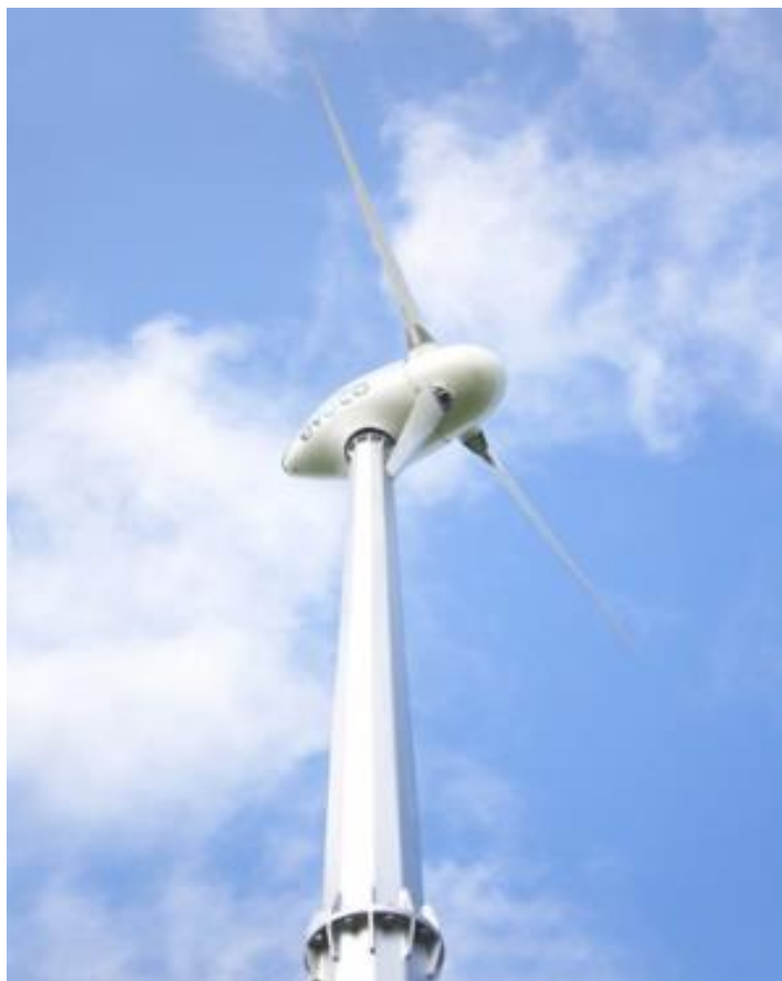
Joonis 3.4. Osiris/Evoco 10kW tuulegeneraator [20]
