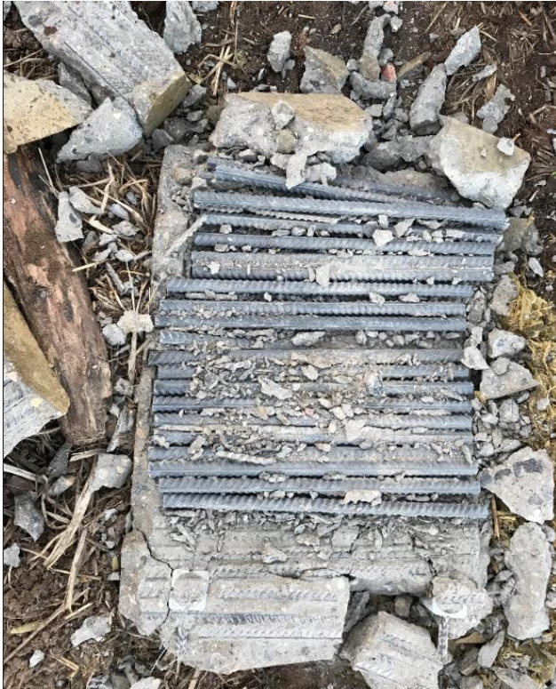
Joonis 5.6. Betoonkehas ja silos olnud katsekehade eemaldamine (Autori foto 2018).
