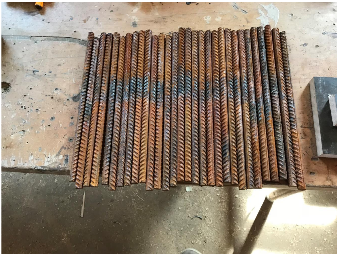
Joonis L.8.3. Agressiivsest keskkonnast eemaldatud katsekehad (Autori foto 2018).
