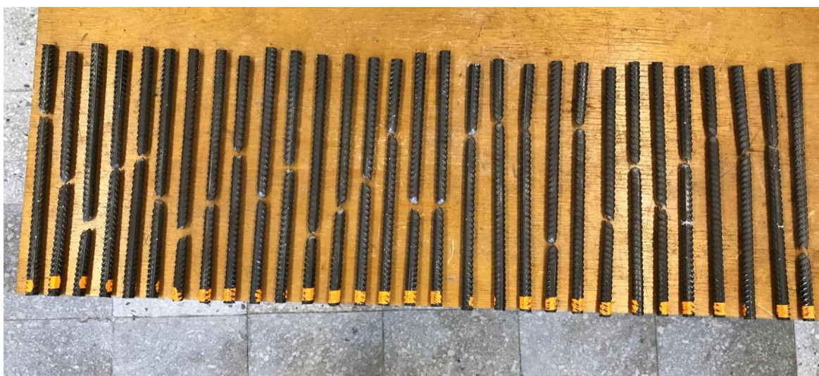
Joonis 5.1. Esimese katseseeria terasvarraste purunemine (Autori foto 2018).
