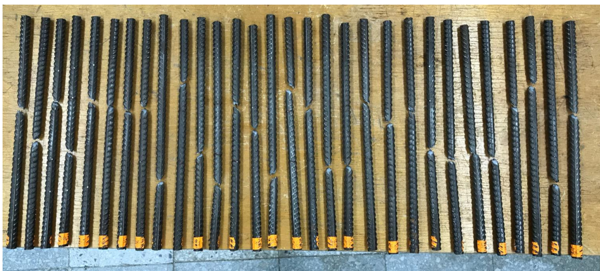
Joonis 5.2. Teise katseseeria terasvarraste purunemine (Autori foto 2018).
