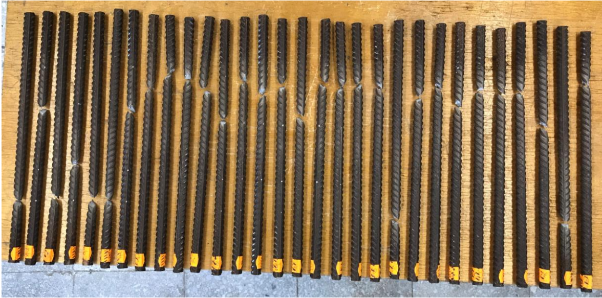
Joonis 5.4. Neljanda katseseeria terasvarraste purunemine (Autori foto 2018).
