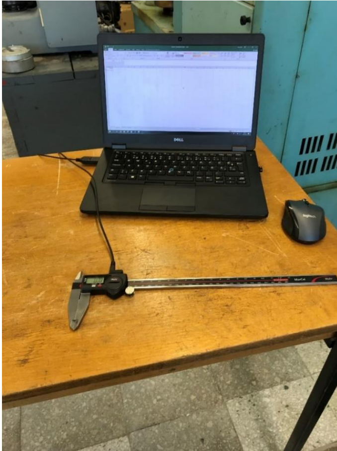
Joonis 4.2. Elektrooniline nihik MAHR 16ER, ühendatud PC-seadmega (Autori foto 2018).
