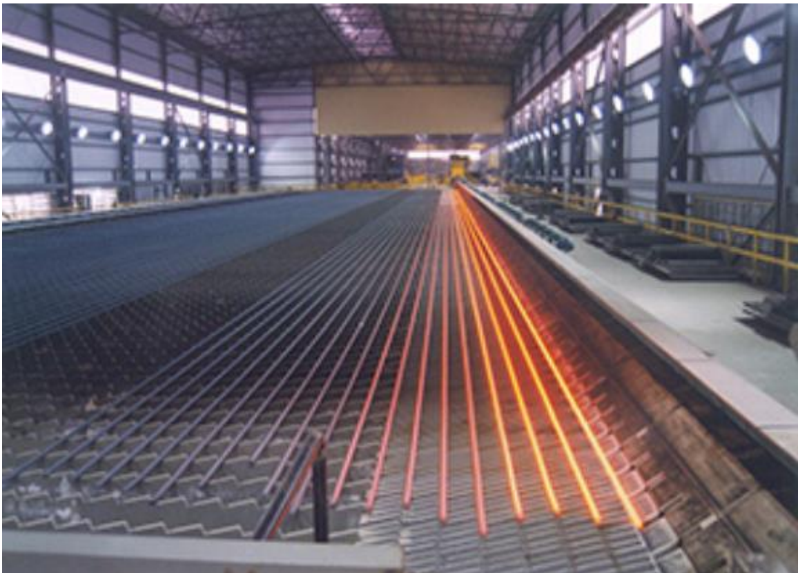
Joonis 1.1. Terassarruse tootmine kuumvaltsimise meetodil (CRSI 2018).
