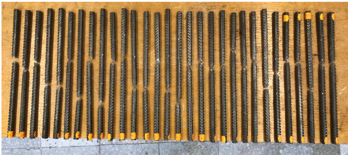
Joonis 5.3. Kolmanda katseseeria terasvarraste purunemine (Autori foto 2018).
