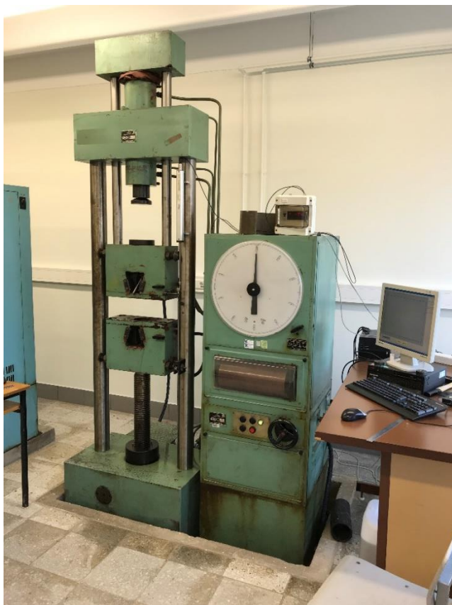
Joonis 4.1. Universaalne katsemasin P-20 (Autori foto 2018).
