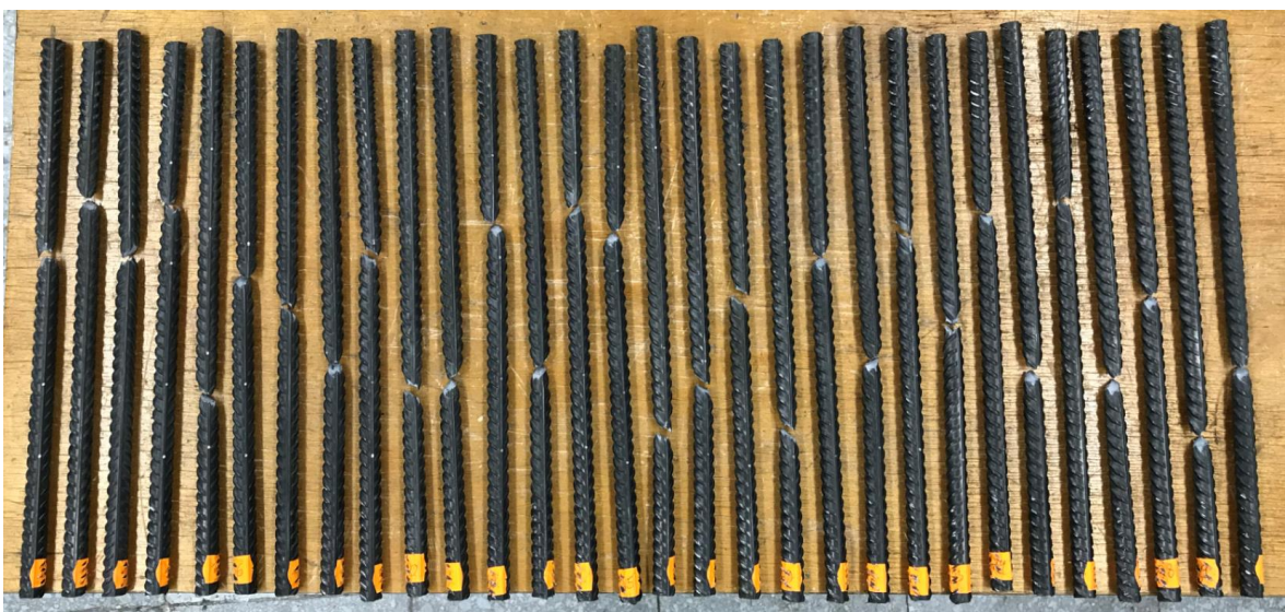
Joonis 5.7. Kuuenda katseseeria terasvarraste purunemine (Autori foto 2018).
