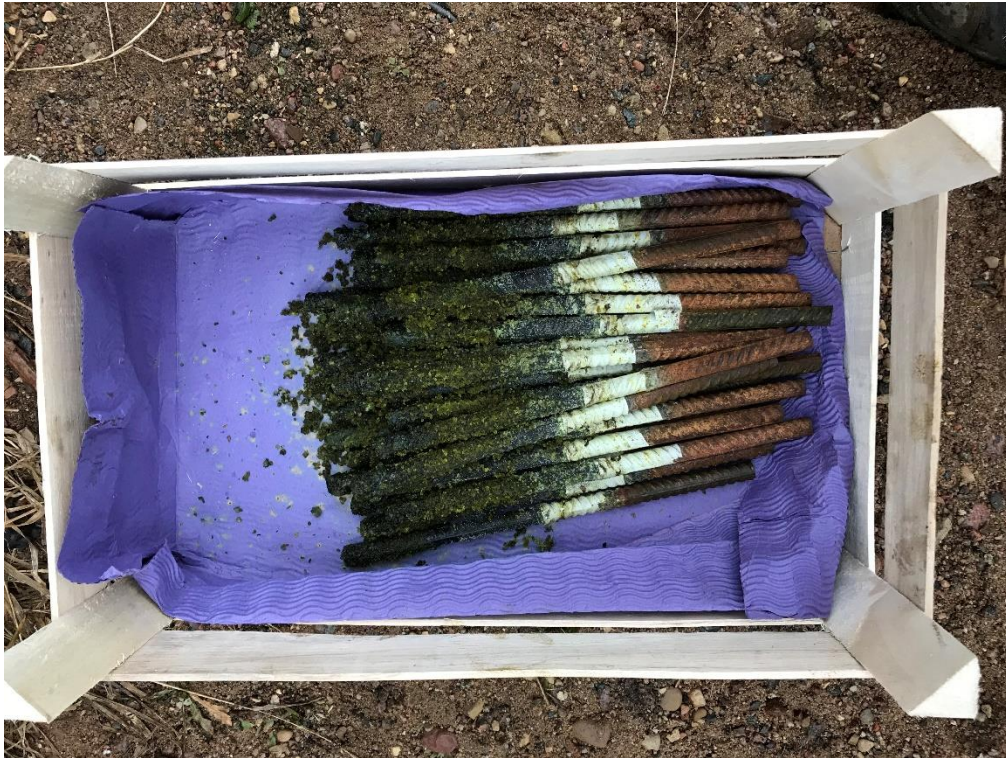
Joonis L.8.1. Osaliselt happelisest keskkonnast eemaldatud katsekehad (Autori foto 2018).
