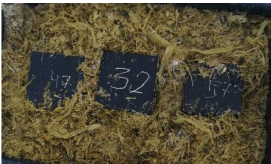
Joonis 2.3. Katsekehade asetsemine silos.
