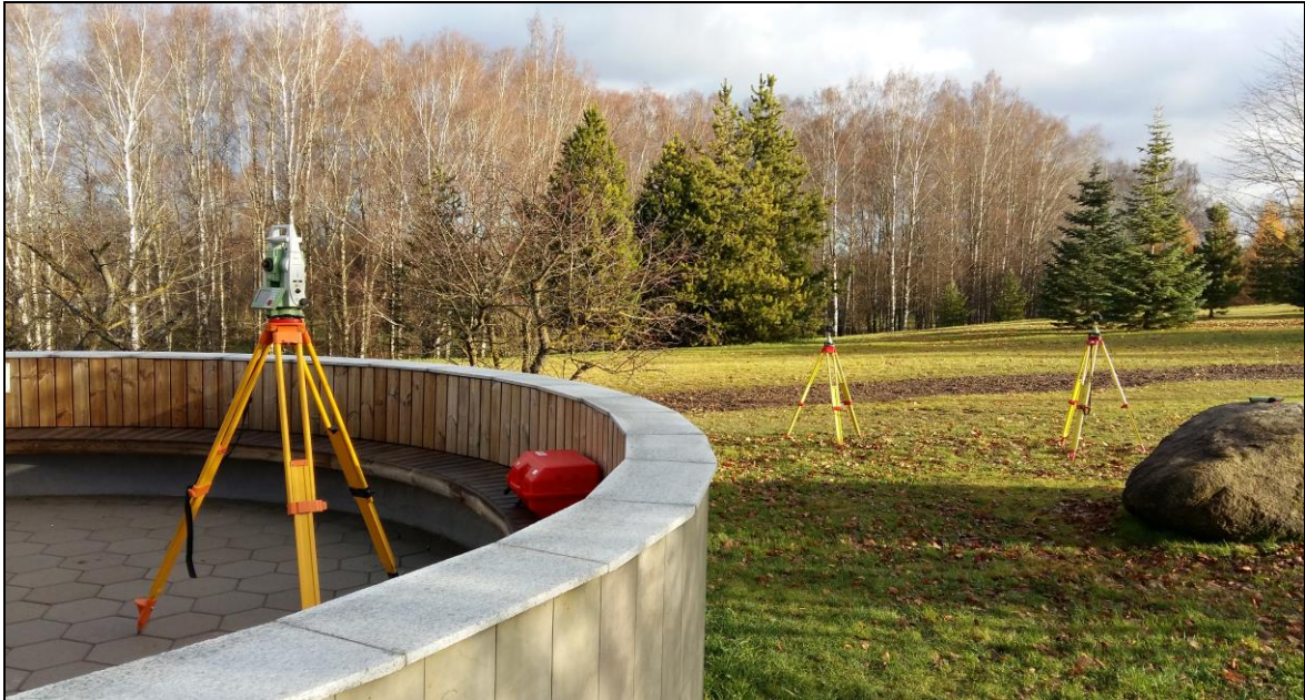
Joonis 7. Elektrontahhümeetri ja statiivide paiknemine
