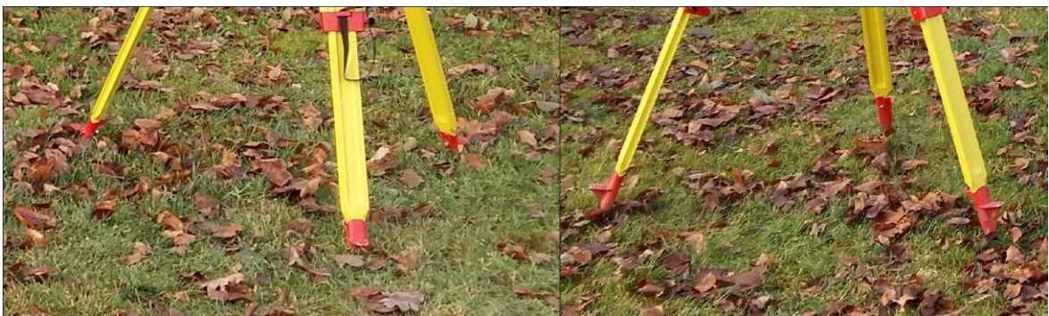
Joonis 8. Statiiv pinnasesse vajutatud (vasakul) ja pinnasesse vajutamata (paremal)
