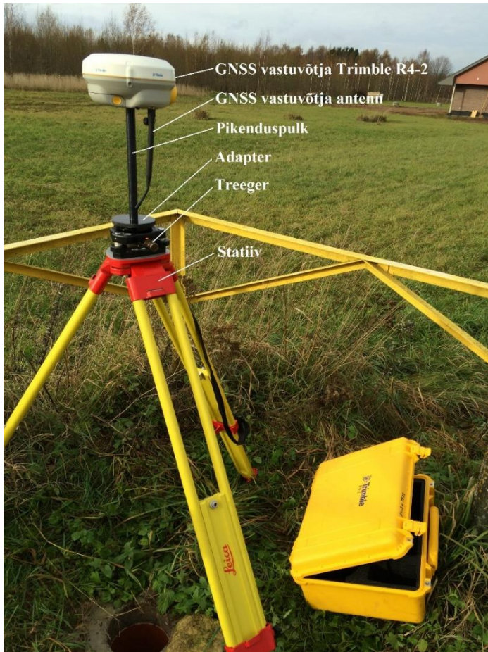
Joonis 12. Töös kasutatud GNSS vastuvõtja Trimble R4-2 põhivõrgupunktil Lemmati97
