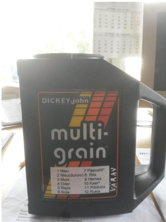
Joonis 1.2 Niiskuse mõõtur multi-grain
