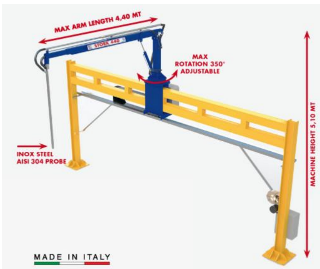
Joonis 4.1 Rööpal liikuv proovivõtusond Stork 440 Rail [16]
