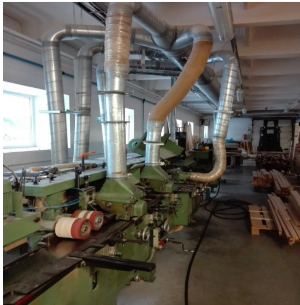
Joonis 14 Mittetöötav seade, mille osad sulgesiibrid on avatud
