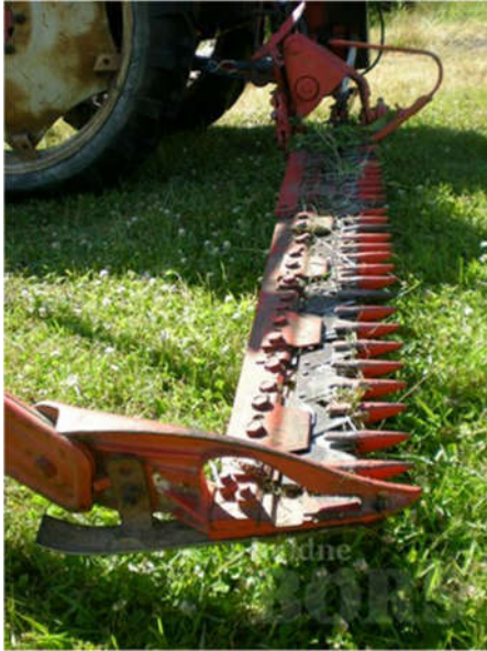
Joonis 3.3. Lattniiduk: a- KC-2.1; b- lattniiduki vântkepsmehhanismi tööpõhimõtte skeem: 1- võll, 2- vânt, 3- keps, 4- vikat, 5- liigend [11]
