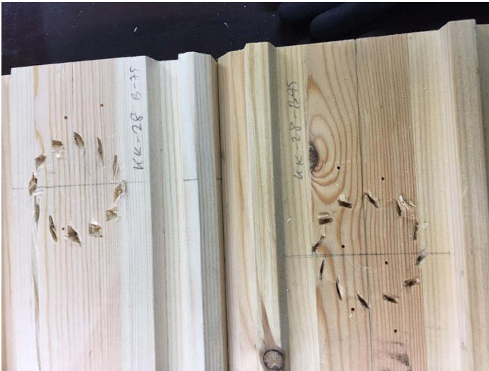
Joonis L5.15. Katsekeha KK28-C1/75 hammastüübli jäljendid katse lõpuks
