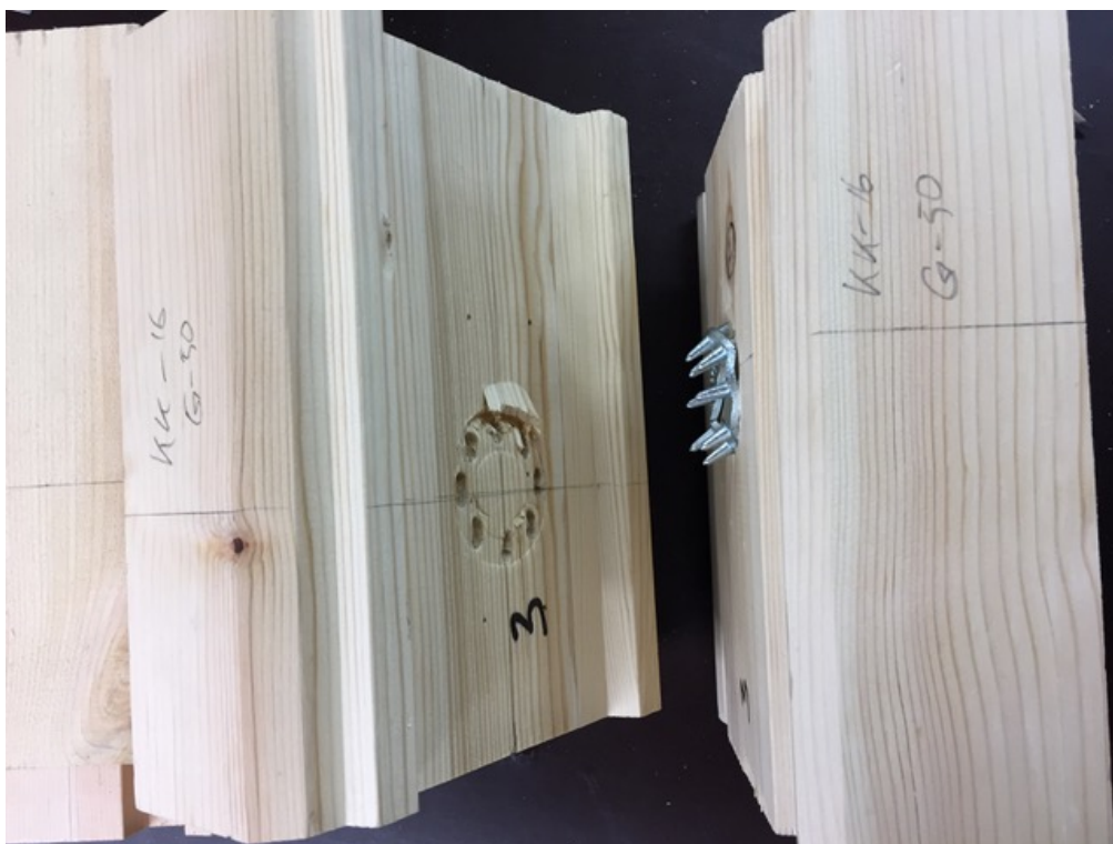
Joonis L4.11. Katsekeha KK16-C10/50 hammastüüpli purunemine
