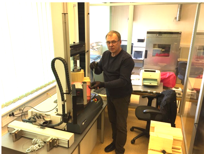
Joonis 2.9. Universaalne elektromehaaniline katsemasin Instron 3369
