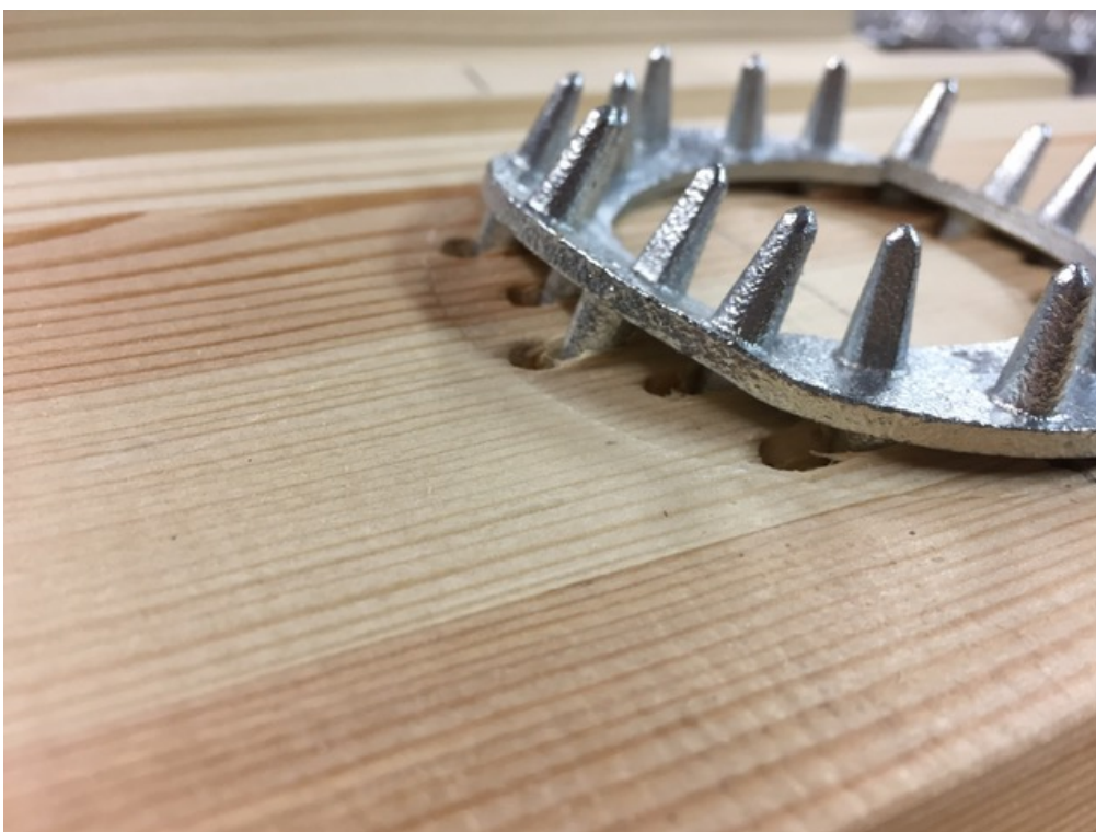
Joonis L3.13. Katsekeha KK7-C10/80 hammastüübli purunemine
