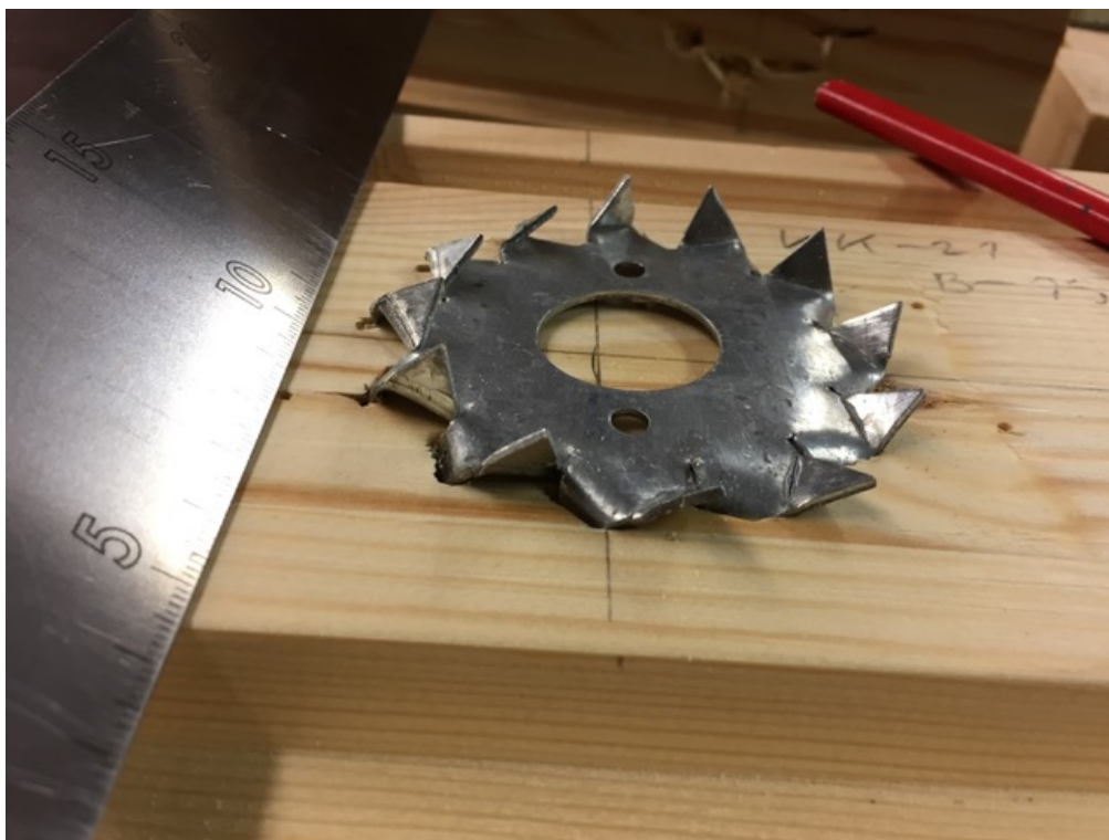
Joonis L5.1. Katsekeha KK21-C1/75 hammastüüpli purunemine
