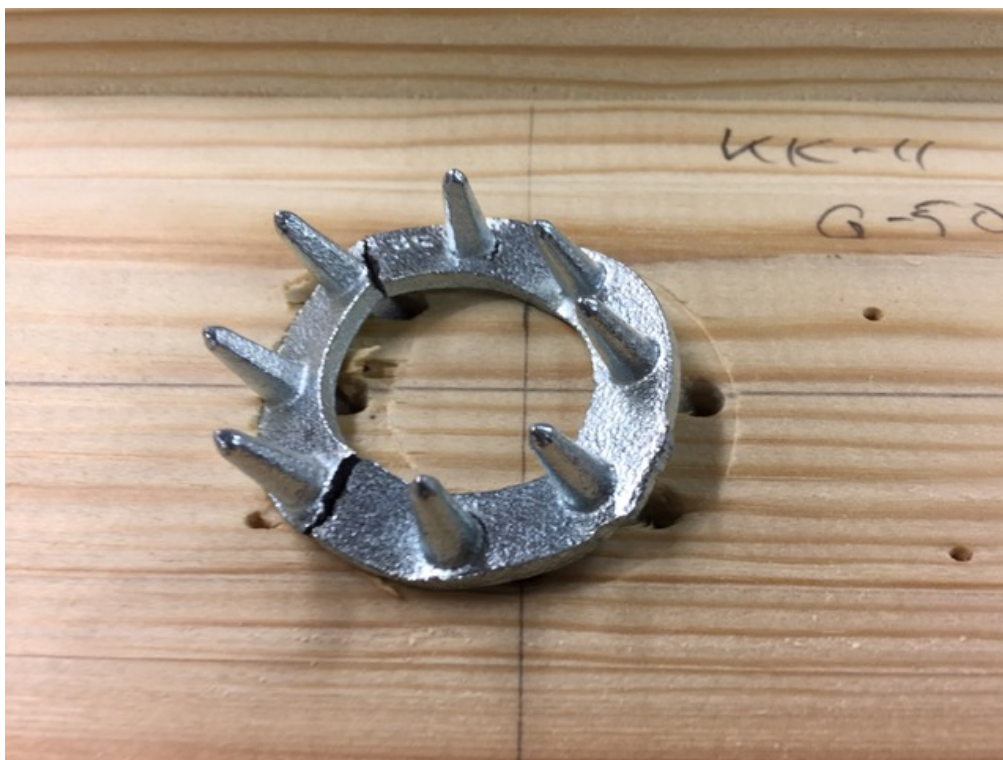
Joonis L4.1. Katsekeha KK10-C10/50 hammastüübli purunemine
