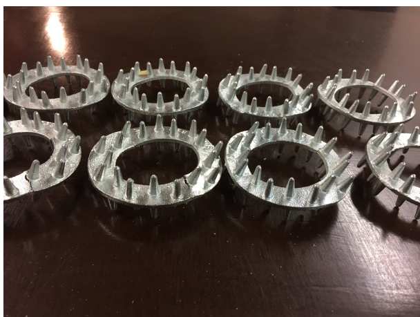
Joonis 3.11. Teise katseseeria C10/80 tüüpi hammastüüblid peale katseid ja uuritud puitpuiduga liite lahti võtmist
