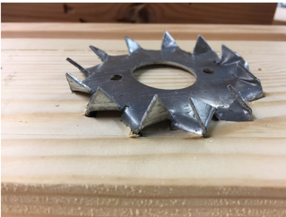
Joonis L5.7. Katsekeha KK24-C1/75 hammastüübli purunemine
