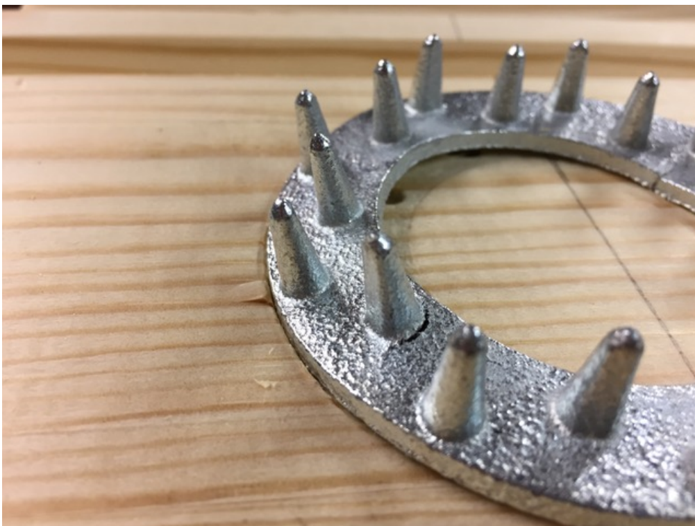
Joonis L3.5. Katsekeha KK3-C10/80 hammastüübli purunemine
