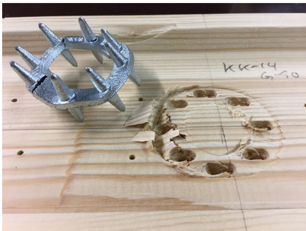
Joonis L4.8. Katsekehale KK14-C10/50 tekkinud hammastüübli jäljend
