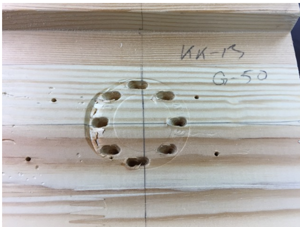
Joonis L4.6. Katsekehale KK13-C10/50 tekkinud hammastüüpli jäljend
