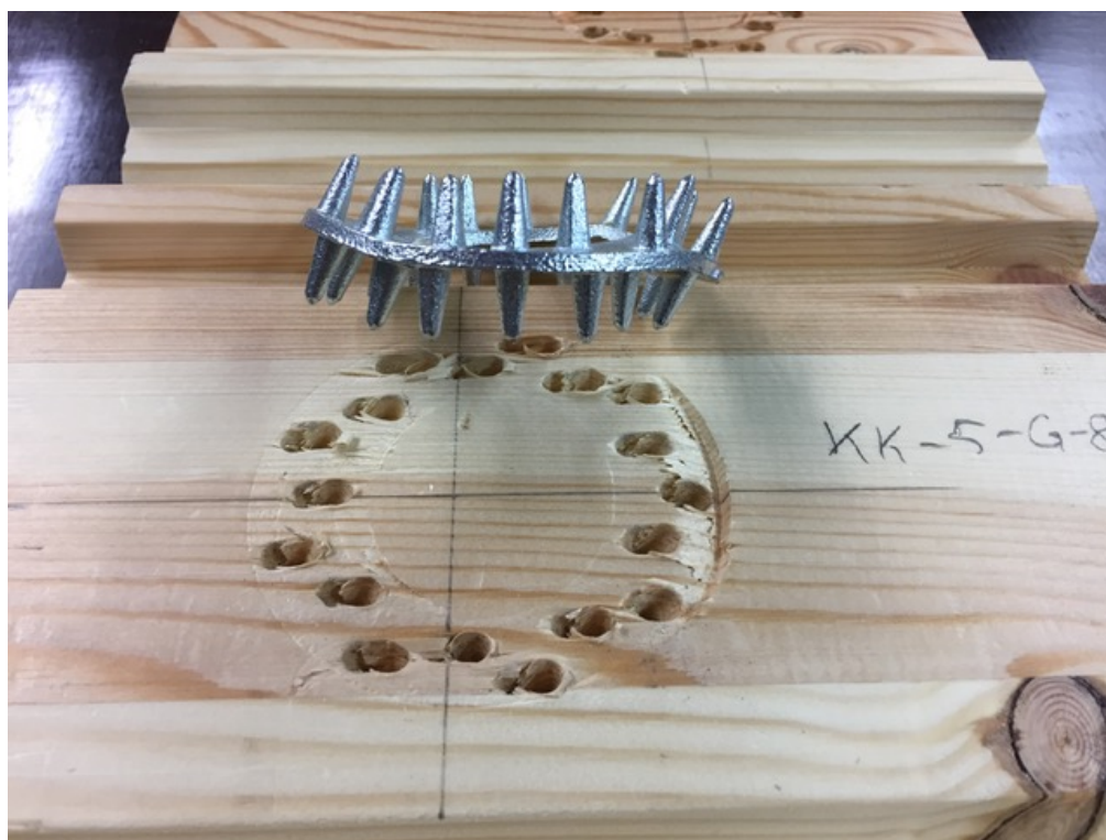
Joonis L3.10. Katsekehale KK5-C10/80 tekkinud hammastüübli jäljend
