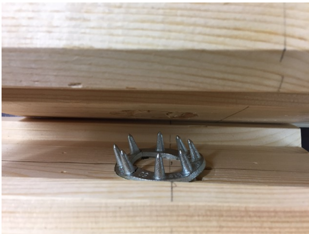
Joonis L6.16. Katsekehale KK38-2xC10/50 tekkinud hammastüübli muljumise jäljend
