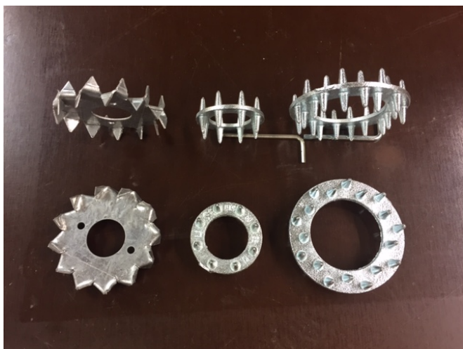
Joonis 2.4. Katsetel kasutatud hammastüüblid. Vasakul tüüp C1 läbimõõduga d_c = 75 mm, keskel tüüp C10 läbimõõduga d_c = 50 mm ja paremal tüüp C10 läbimõõduga d_c = 80 mm
