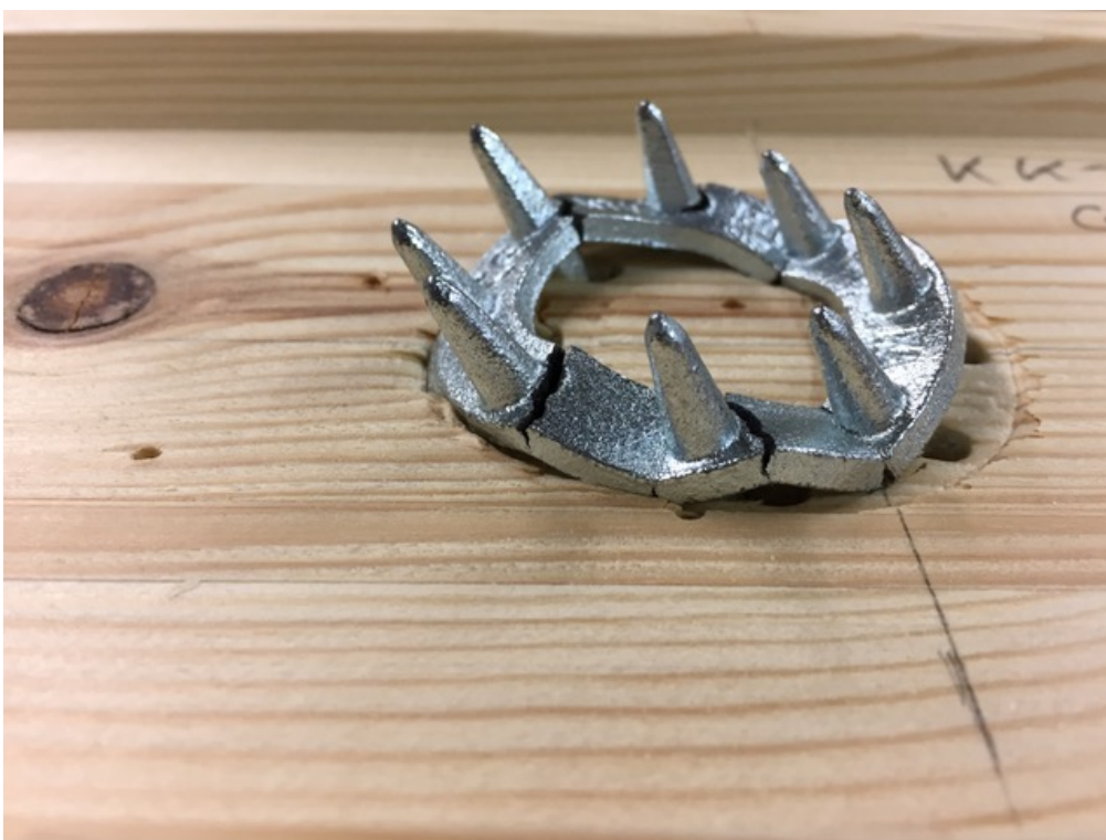
Joonis L4.9. Katsekeha KK15-C10/50 hammastüübli purunemine
