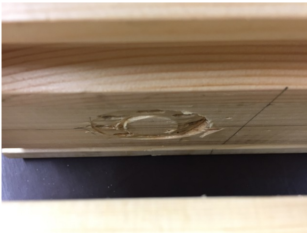
Joonis L6.6. Katsekehale KK33-2xC10/50 tekkinud hammastüüpli muljumise jäljend
