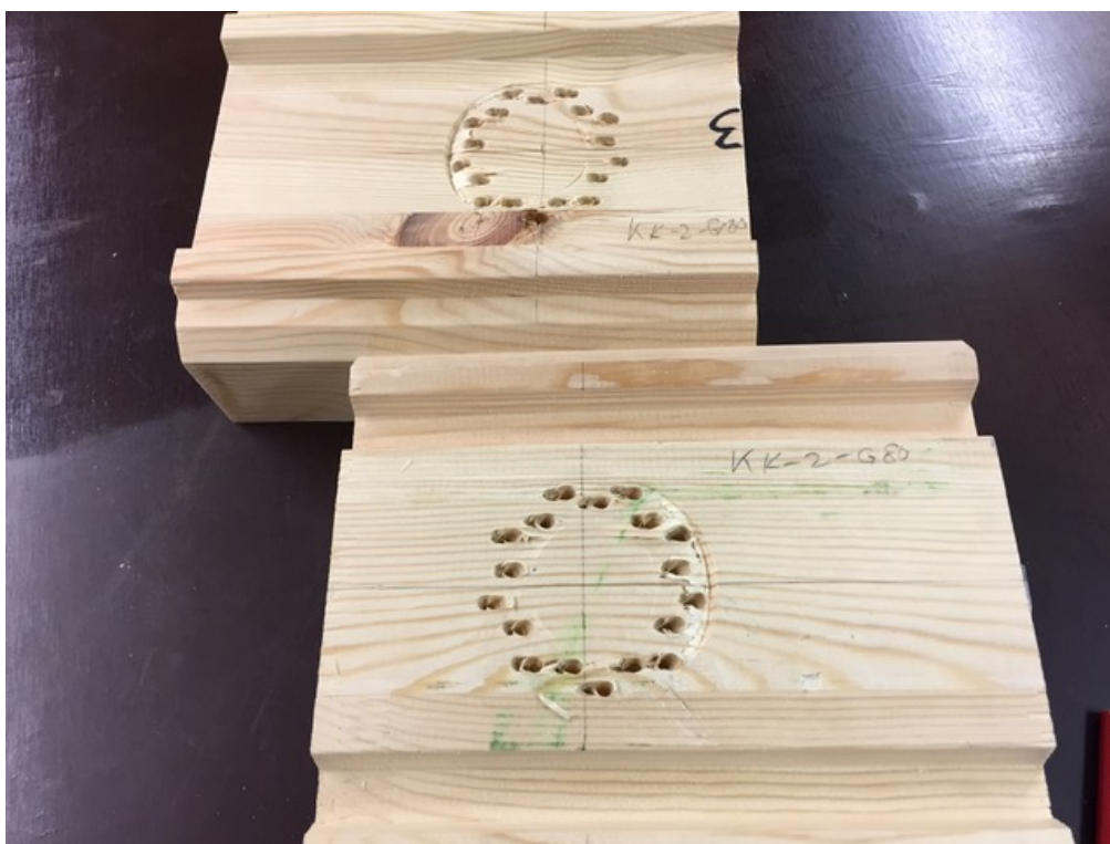
Joonis L3.4. Katsekehale KK2-C10/80 tekkinud hammastüübli jäljend
