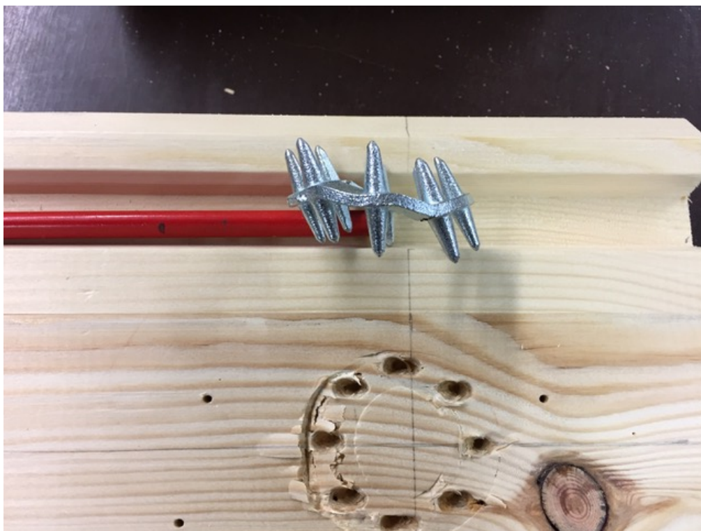
Joonis L14.12. Katsekehale KK16-C10/50 tekkinud hammastüüpli jäljend
