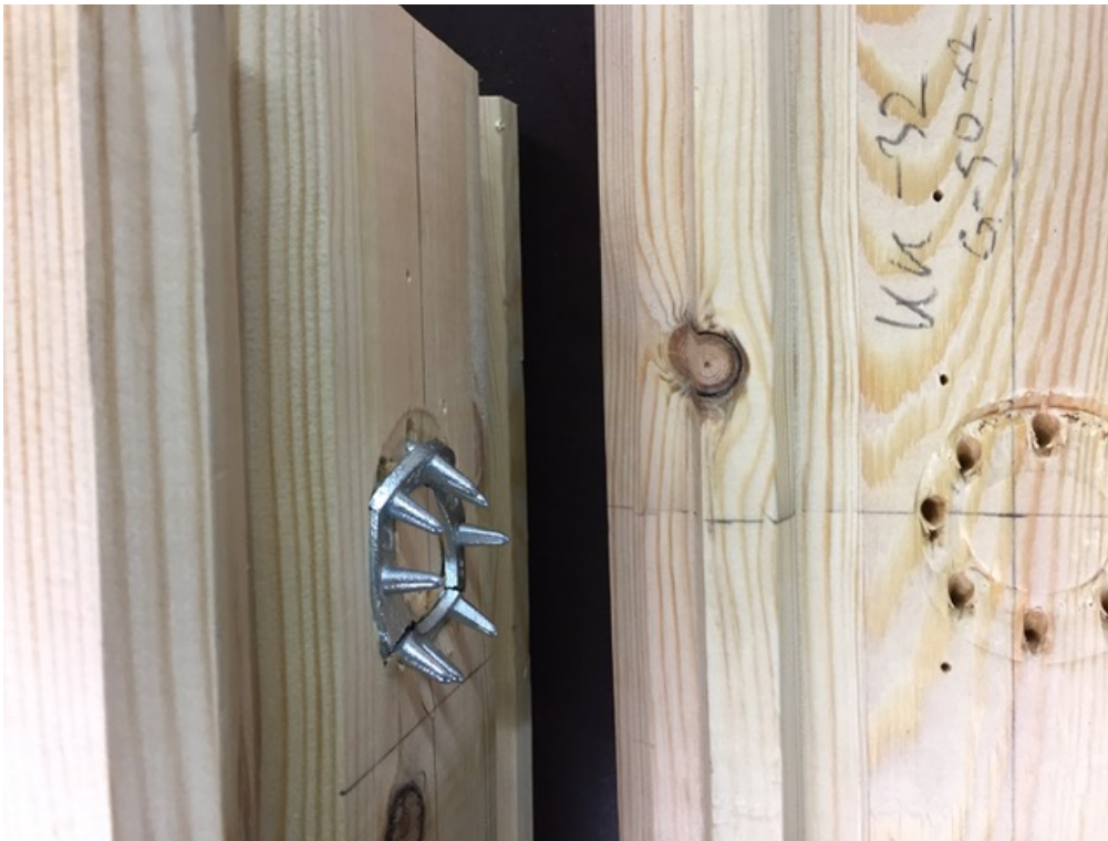
Joonis L6.3. Katsekeha KK32-2xC10/50 hammastüübli purunemine
