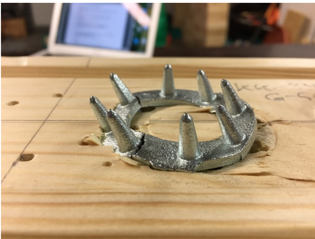
Joonis L6.7. Katsekeha KK34-2x10/50 hammastüübli purunemine
