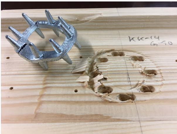
Joonis 3.9. C10/50 tüüpi hammastüübli tüüpiline purunemispilt ja liite puitelemendi muljumine ühelõikelise katsel
