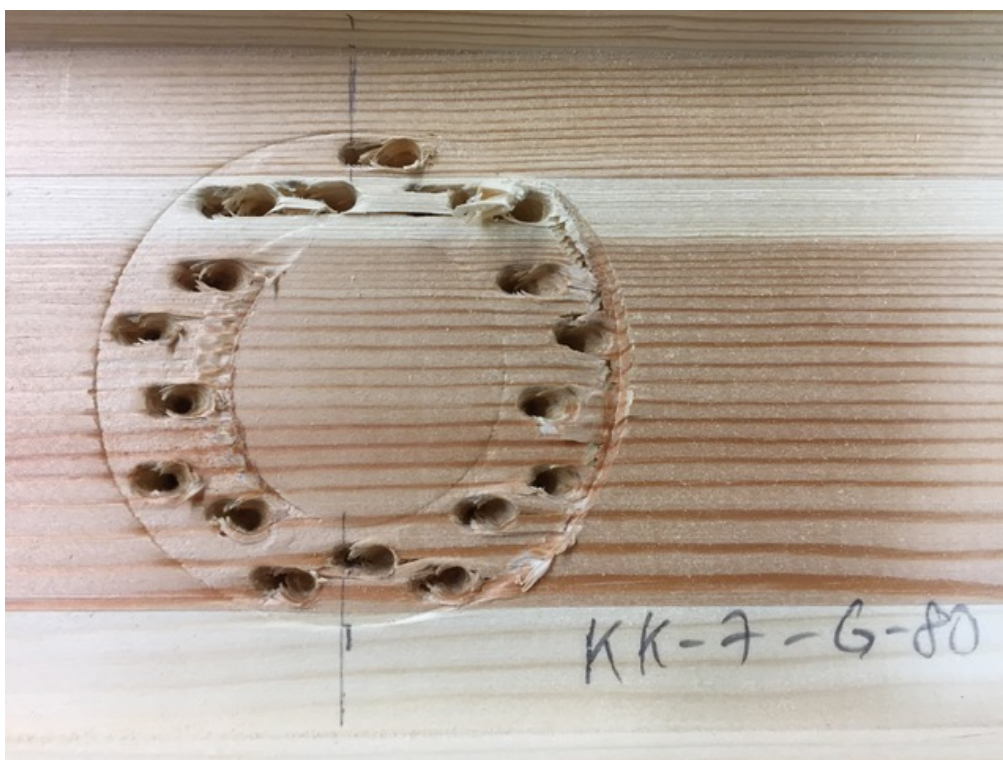
Joonis L3.14. Katsekehale KK7-C10/80 tekkinud hammastüübli jäljend
