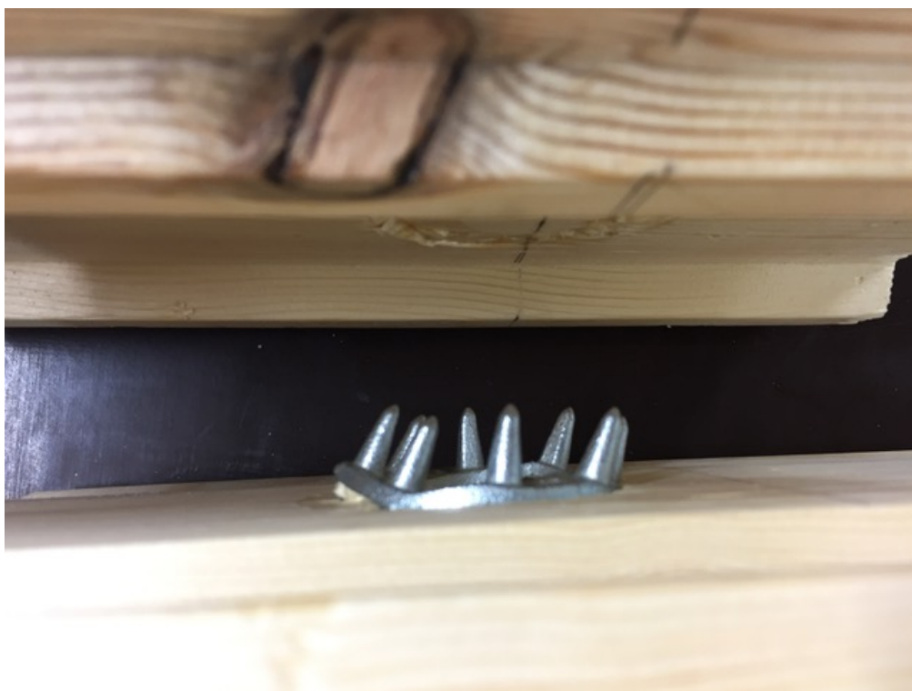
Joonis L6.9. Katsekeha KK35-2xC10/50 hammastüüpli purunemine
