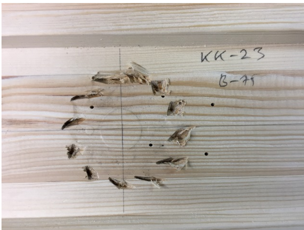
Joonis L5.6. Katsekehale KK23-C1/75 tekkinud hammastüübli jäljed
