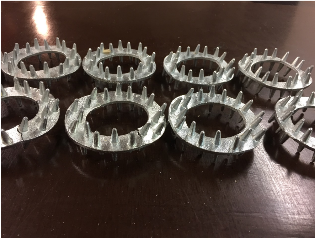
Joonis L3.21. Katsetel kasutatud C10/80 tüüpi hammastüübli iseloomulik purunemispilt
