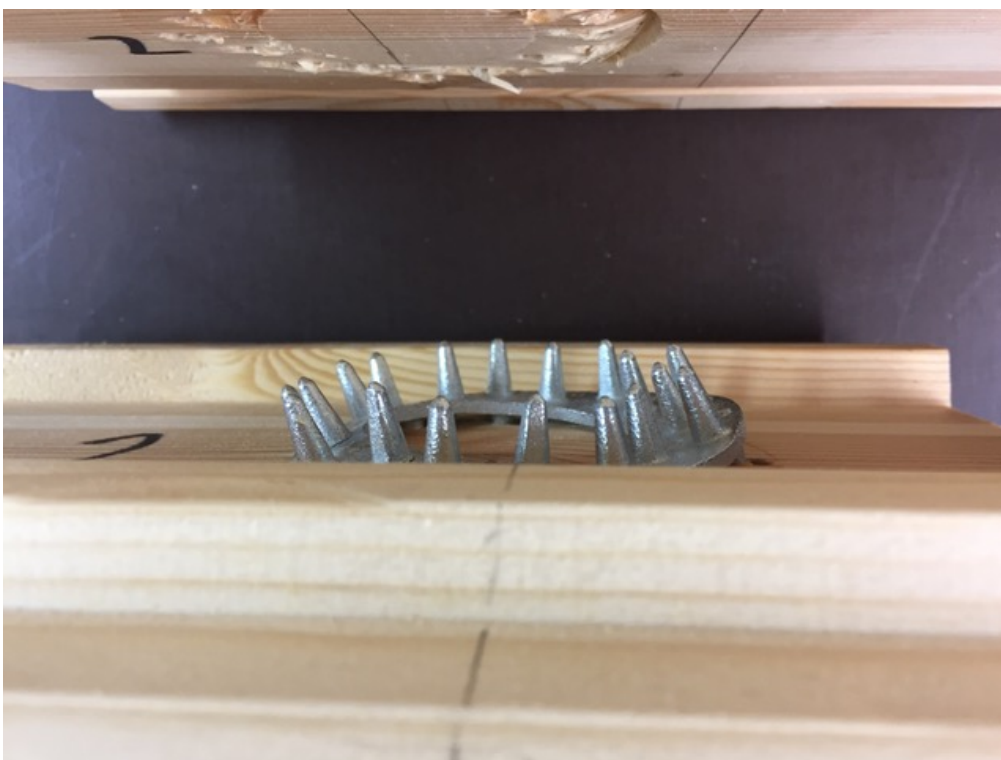
Joonis L3.11. Katsekeha KK6-C10/80 hammastüübli purunemine
