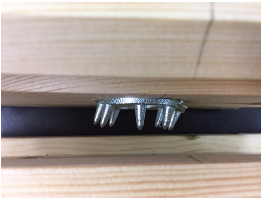
Joonis L6.5. Katsekeha KK33-2xC10/50 hammastüüpli purunemine
