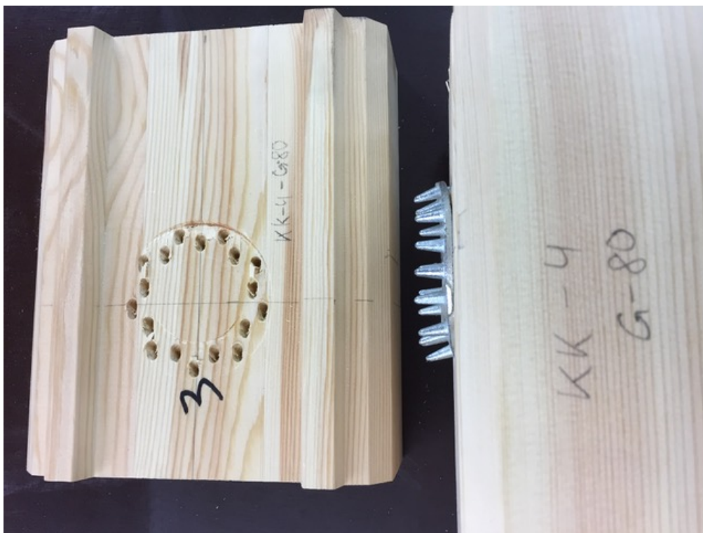
Joonis L3.8. Katsekehale KK4-C10/80 tekkinud hammastüübli jäljed
