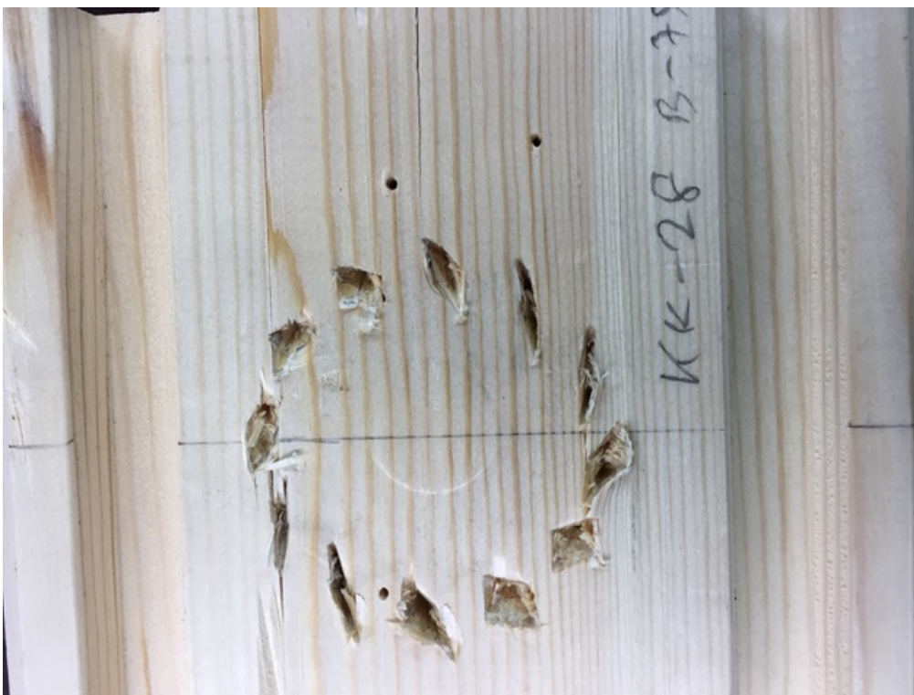
Joonis L5.16. Katsekehale KK28-C1/75 tekkinud hammastüübli jäljend lähemalt. Fotol on ilmekalt näha hammastüübli kidade nihkumine pikikiudu ja kiududega rohkem risti olevate hammaste muljumise jäljend
