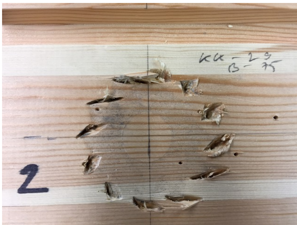
Joonis L5.18. Katsekehale KK29-C1/75 tekkinud hammastüübli jäljend
