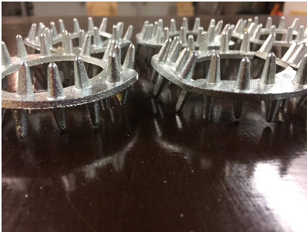
Joonis L3.22. Katsetel kasutatud C10/80 tüüpi hammastüübli iseloomulik väändumine
