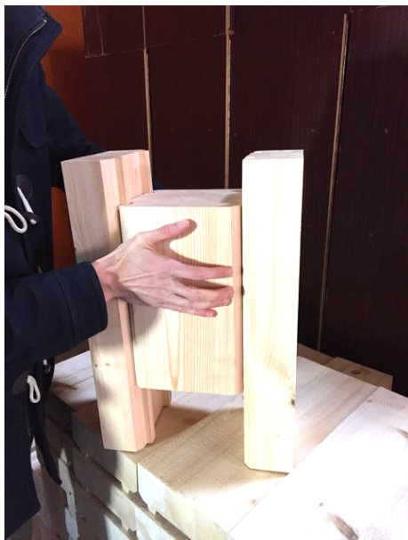
Joonis 2.7. Palgist lõigatud kahelõikelise katse elemendid.
