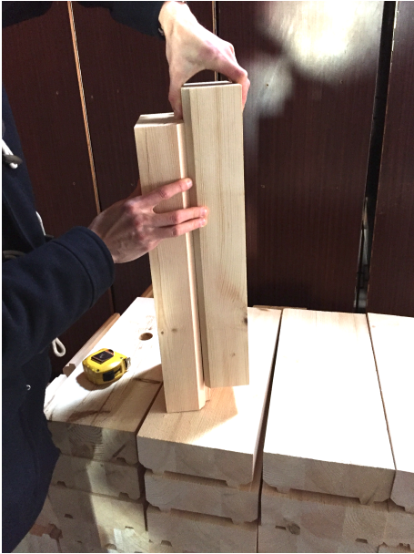
Joonis 2.5. Plankliimpuidust valmistatud seinapalkidest lõigatud katsekehad. Vasakpoolne katsekeha on lõigatud palgi ülemise poole varaga, parempoolne katsekeha on lõigatud palgi alumise poole varaga
