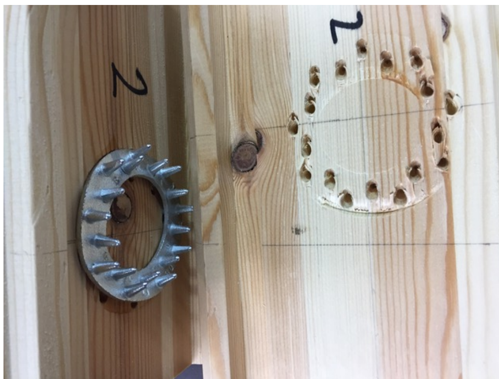
Joonis L3.12. Katsekehale KK6-C10/80 tekkinud hammastüübli jäljed
