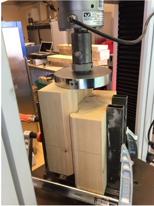
Joonis 2.11. Pitskruvide kasutamine katsekehasid toestava metallraami kooshoidmisel
