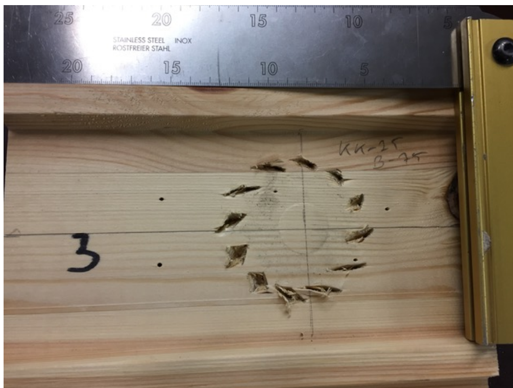
Joonis L5.10. Katsekehale KK25-C1/75 tekkinud hammastüübli jäljed
