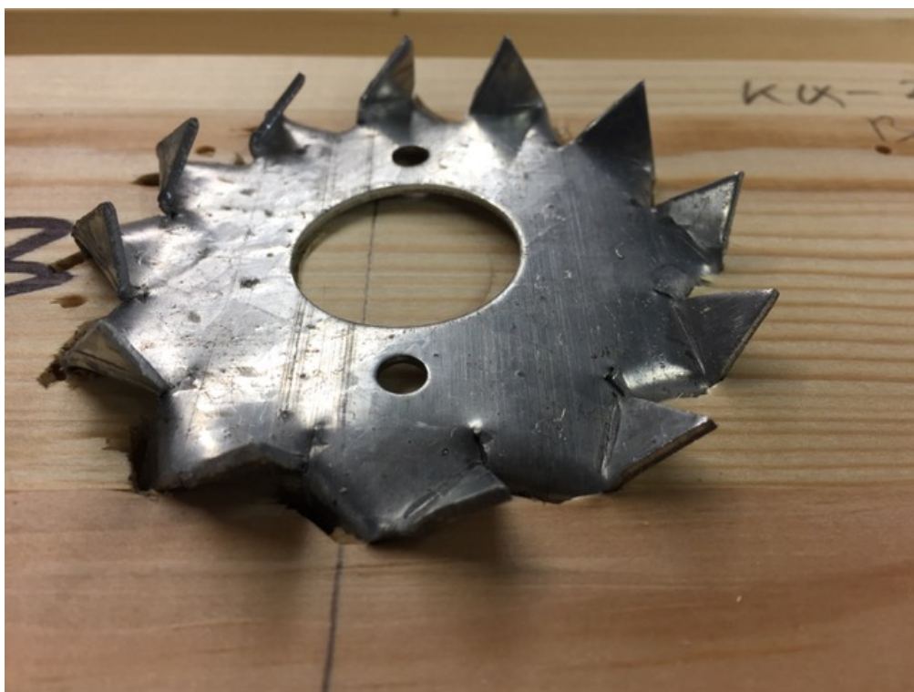
Joonis L5.9. Katsekeha KK25-C1/75 hammastüübli purunemine
