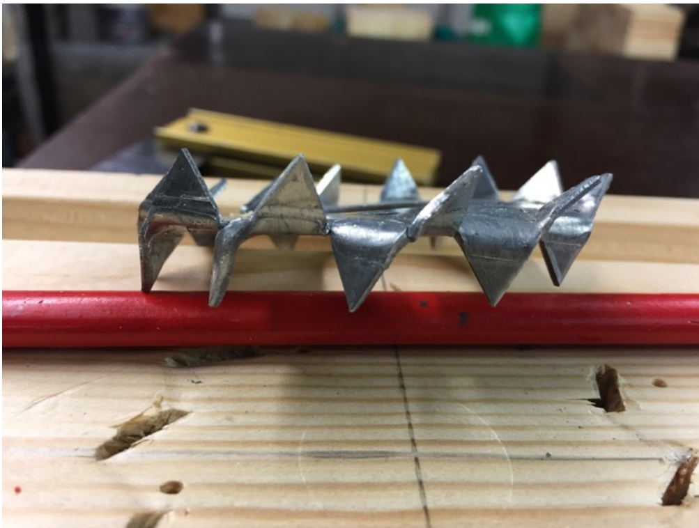
Joonis L5.20. Katsekeha KK30-C1/75 hammastüübli ilmekas kidade muljumine ühel küljel
