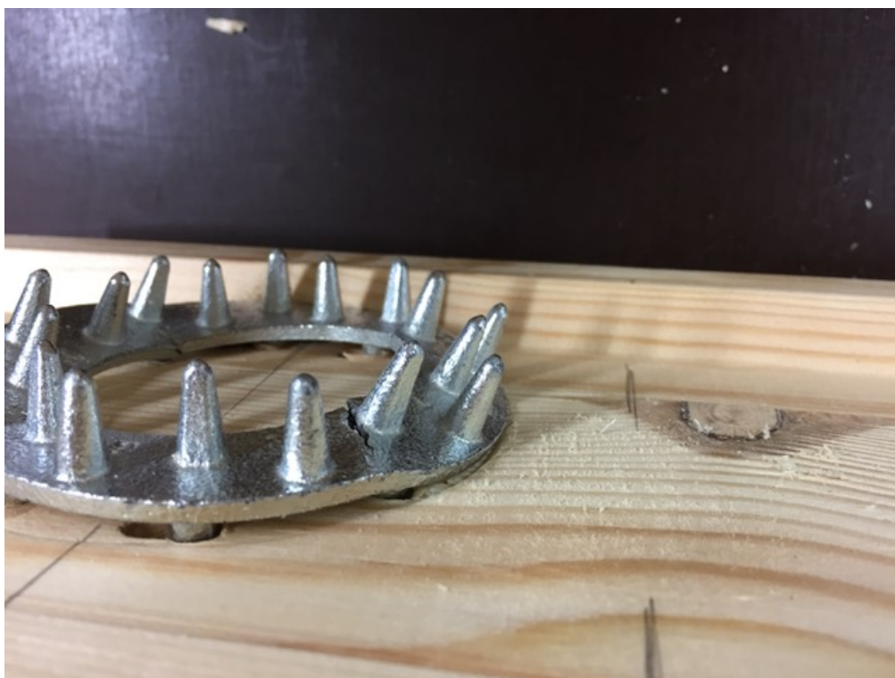
Joonis L3.15. Katsekeha KK8-C10/80 hammastüübli purunemine
