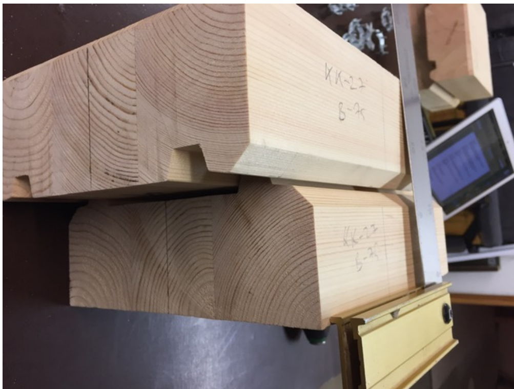
Joonis L5.14. Katsekeha KK27 lahknemine katse lõpuks
