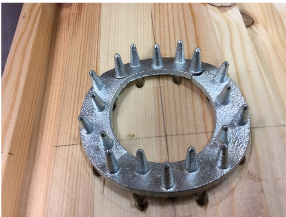
Joonis L3.9. Katsekeha KK5-C10/80 hammastüübli purunemine
