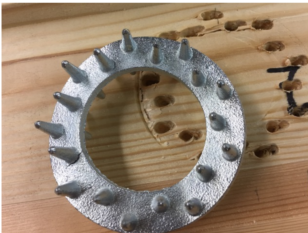
Joonis L3.19. Katsekeha KK10-C10/80 hammastüübli purunemine
