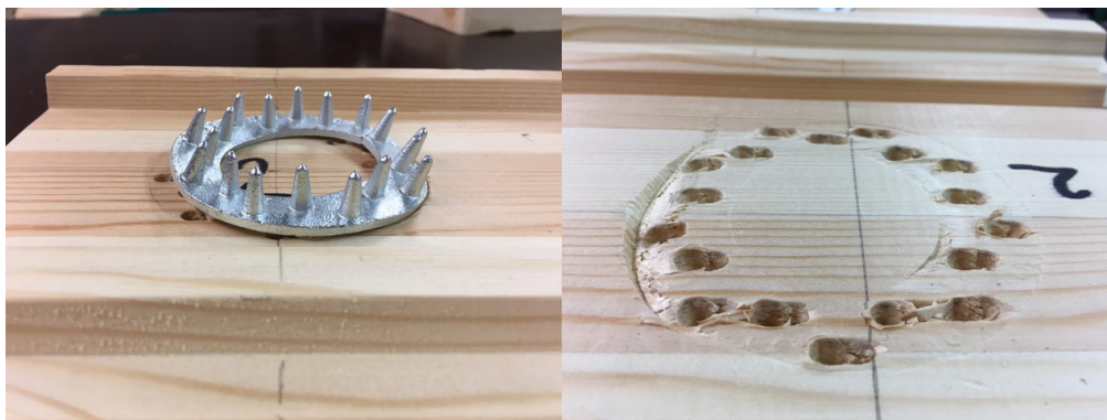
Joonis 3.10. Teise katseseeria katsekehade tüüpiline purunemispilt. Vasakul joonisel on toodud hammastüübli C10/80 deformeerumine, paremal joonisel hammastüübli tekitatud muljumisjäljed puitelemendis
