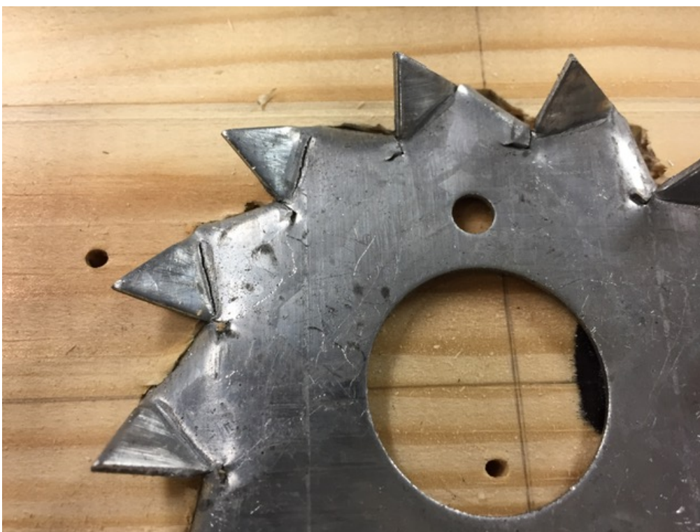
Joonis L5.17. Katsekeha KK29-C1/75 hammastüübli purunemine
