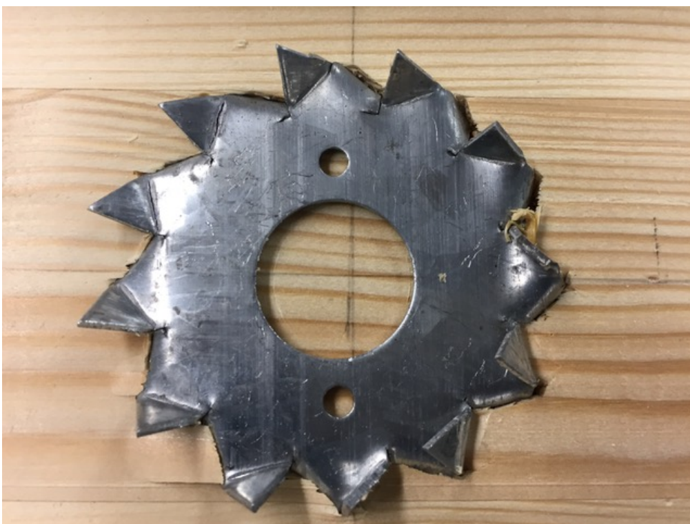
Joonis L.3. Katsekeha KK22-C1/75 hammastüübli purunemine
