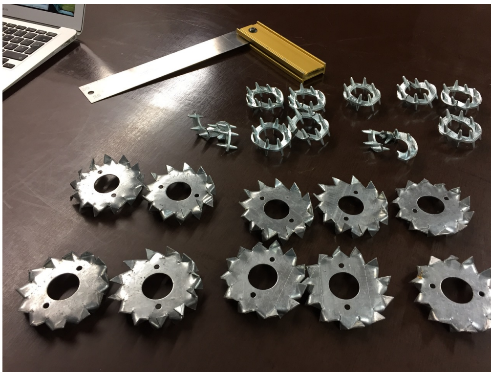
Joonis L5.22. Hammastüüblite C1/75 iseloomulik hammaste muljumine jõu mõjumise suunas
