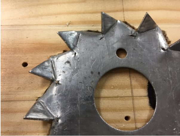
Joonis 3.12. Kolmanda katseseeria hammastüüblite tüüpiline deformeerumine katsete lõpuks
