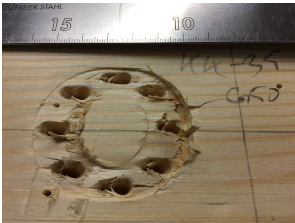
Joonis L6.10. Katsekehale KK35-2xC10/50 tekkinud hammastüüpli muljumise jäljend
