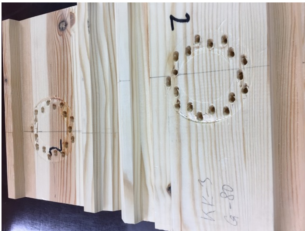
Joonis L3.6. Katsekehale KK3-C10/80 tekkinud hammastüübli jäljed
