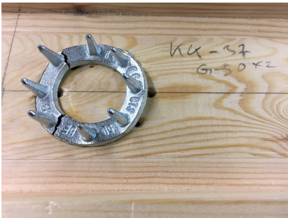
Joonis L6.13. Katsekeha KK37-2xC10/50 hammastüübli purunemine
