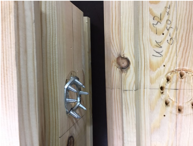
Joonis 3.14. Kahelõikelise katse ühe lõike tüüpiline purunemispilt
