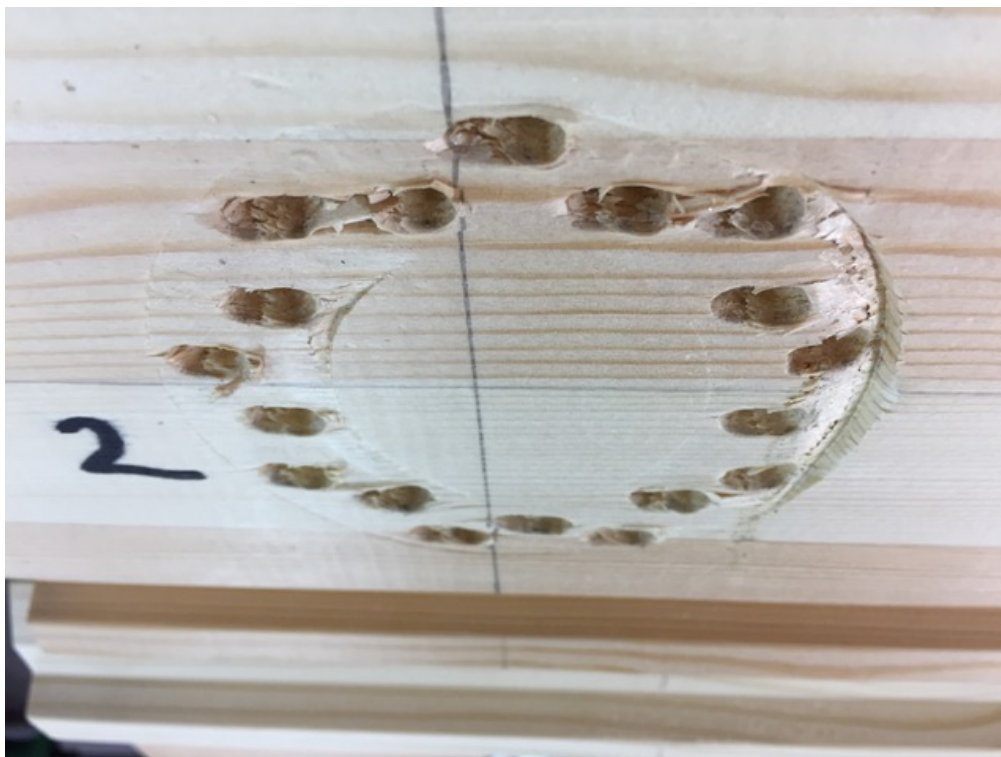
Joonis L3.2. Katsekehale KK1-C10/80 tekkinud hammastüübli jäljend
