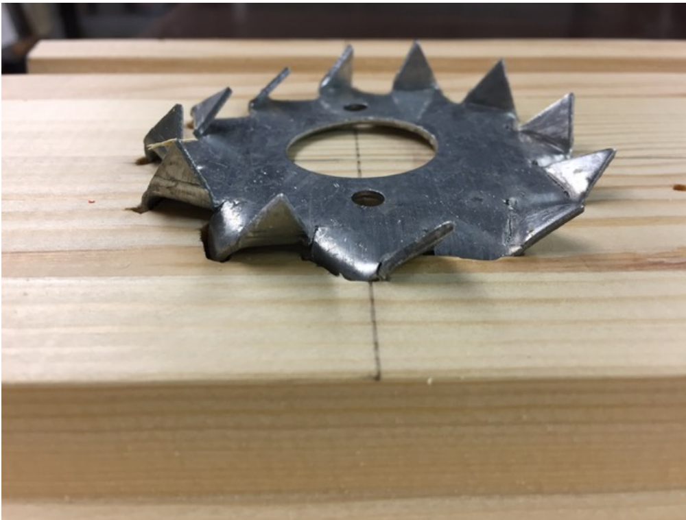
Joonis L5.19. Katsekeha KK30-C1/75 hammastüübli purunemine
