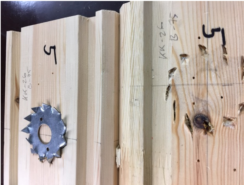
Joonis L5.11. Katsekeha KK26-C1/75 hammastüübli purunemine ja jäljend vastaspoole elemendis
