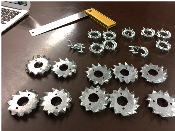
Joonis 3.13. Teise ja kolmanda katseseeria hammastüüblite katsejärgne deformatsioonipiltide võrdlus
