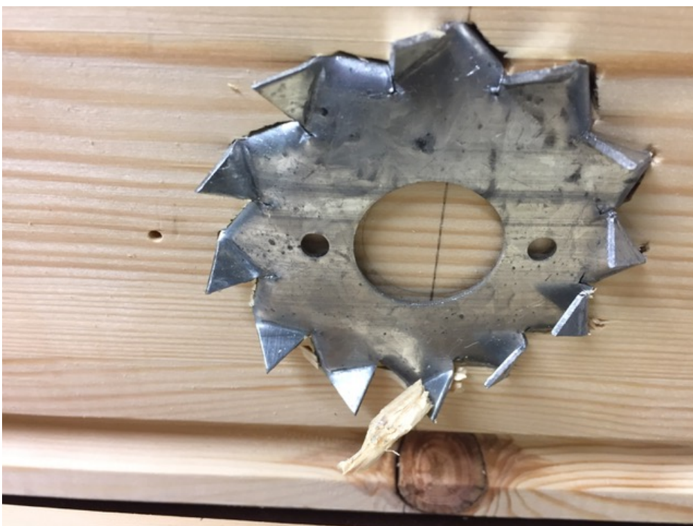
Joonis L5.5. Katsekeha KK23-C1/75 hammastüübli purunemine
