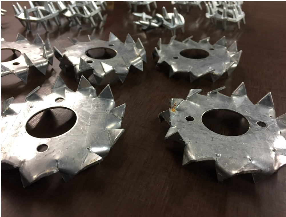
Joonis L5.21. Hammastüüblite C1/75 tüüpiline purunemispilt katse lõpuks
