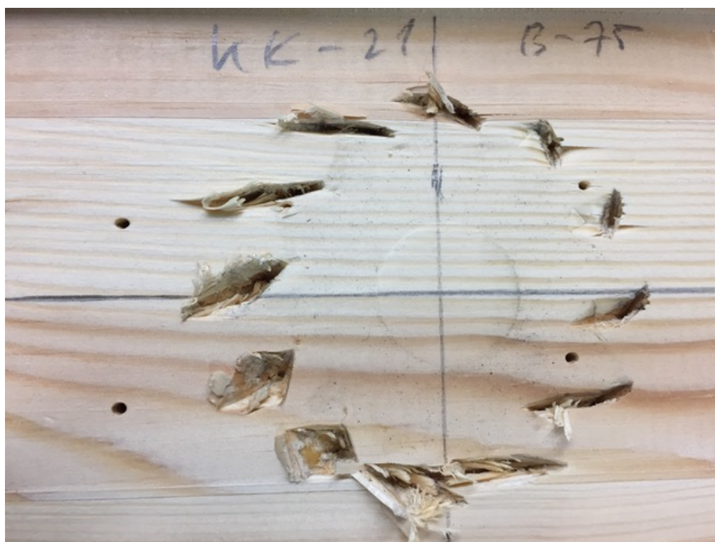
Joonis L5.2. Katsekehale KK21-C1/75 tekkinud hammastüüpli jäljend
