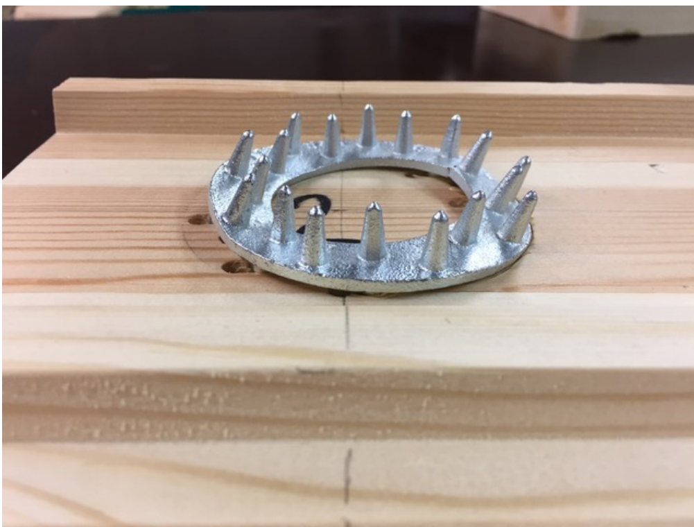
L3.1. Katsekeha KK1-C10/80 hammastüübli purunemine
