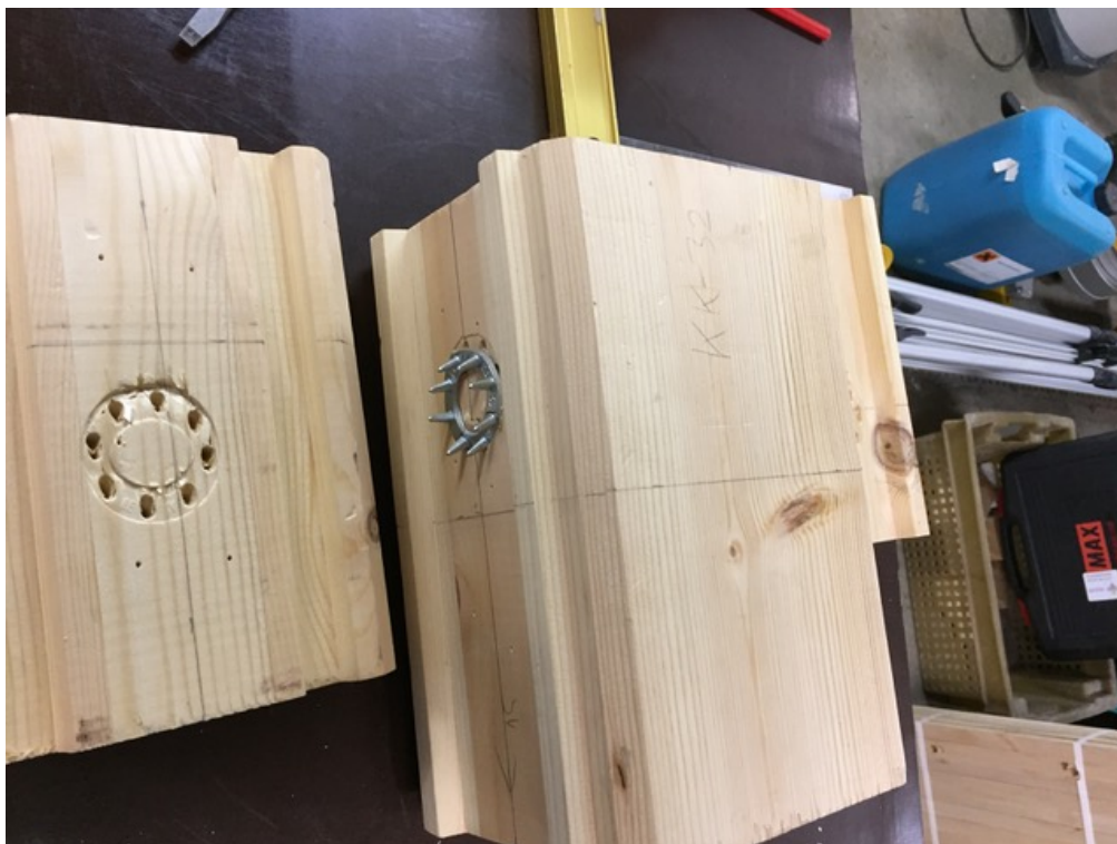
Joonis L6.4. Katsekehale KK32-2xC10/50 tekkinud hammastüübli muljumise jäljed
