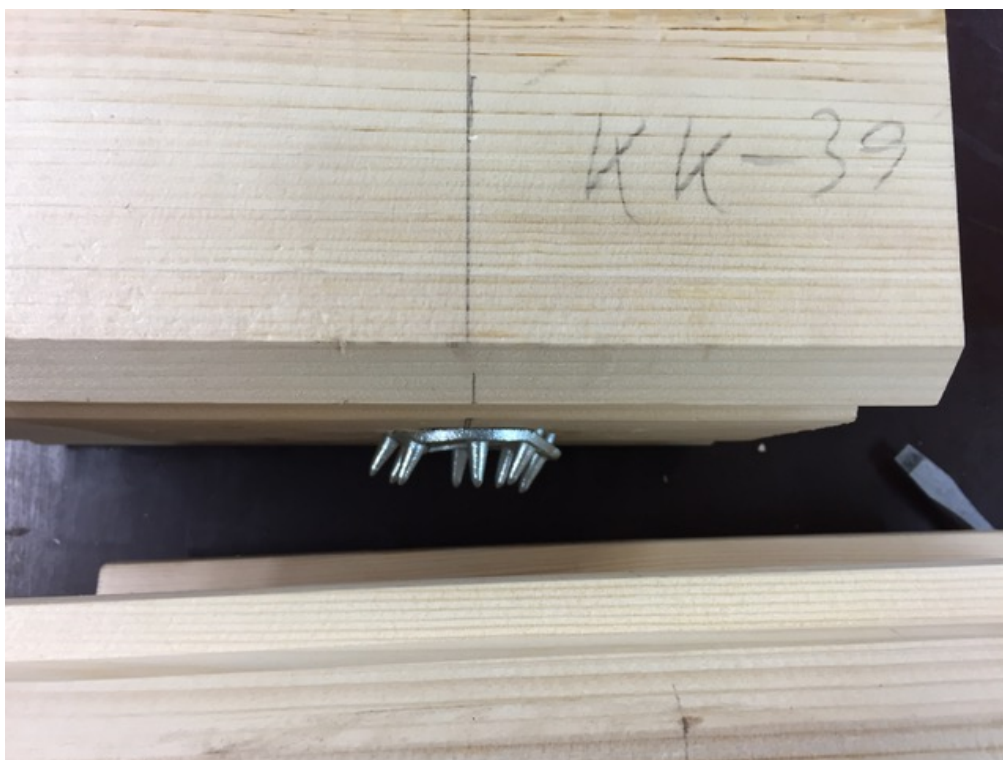
Joonis L6.17. Katsekeha KK39-2xC10/50 hammastüübli purunemine
