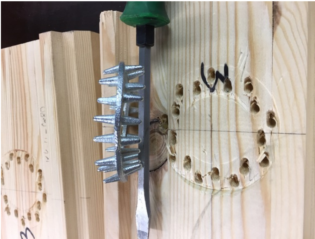
Joonis L3.7. Katsekeha KK4-C10/80 hammastüübli purunemine
