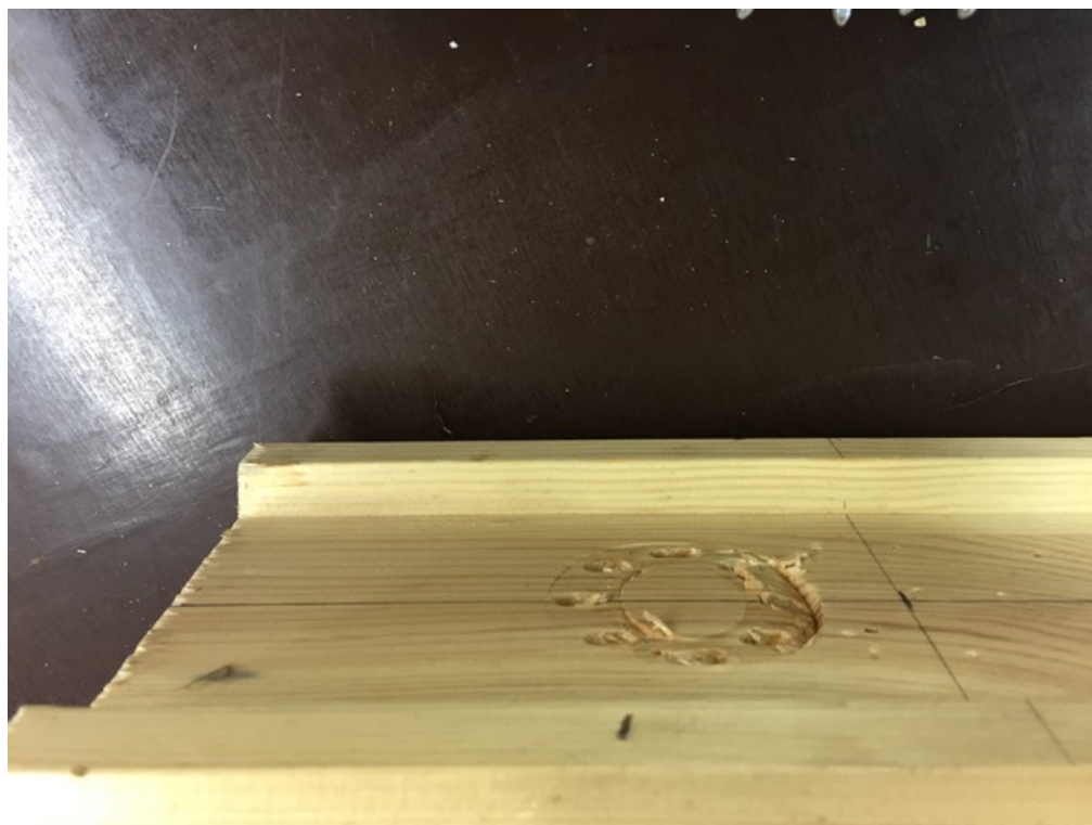
Joonis L6.20. Katsekehale KK40-2xC10/50 tekkinud hammastüübli muljumise jäljend
