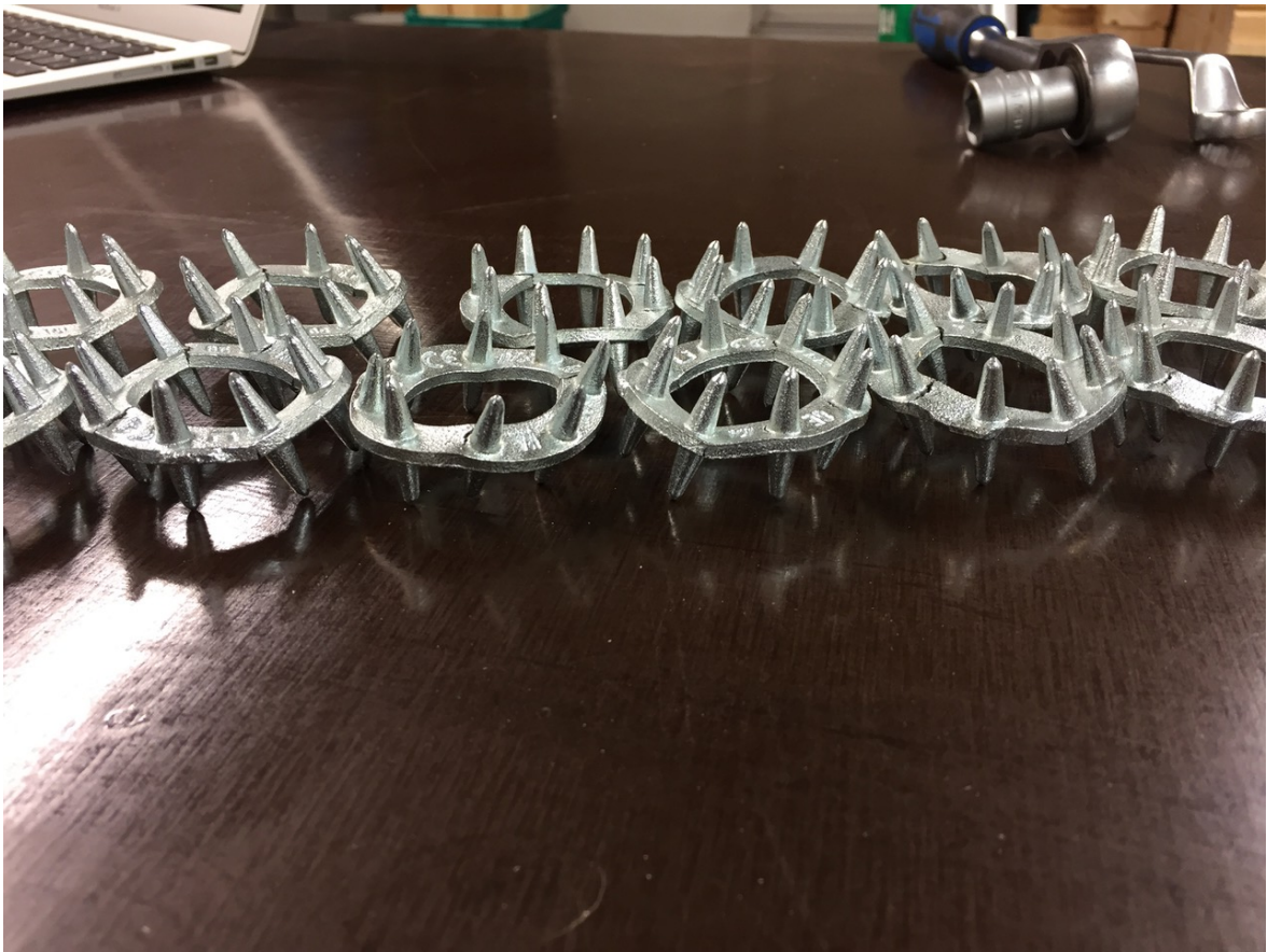
Joonis L6.21. Kahelõikelisel katsel deformeerunud C10 tüüpi hammastüüblid, läbimõõt d_c = 50 mm
