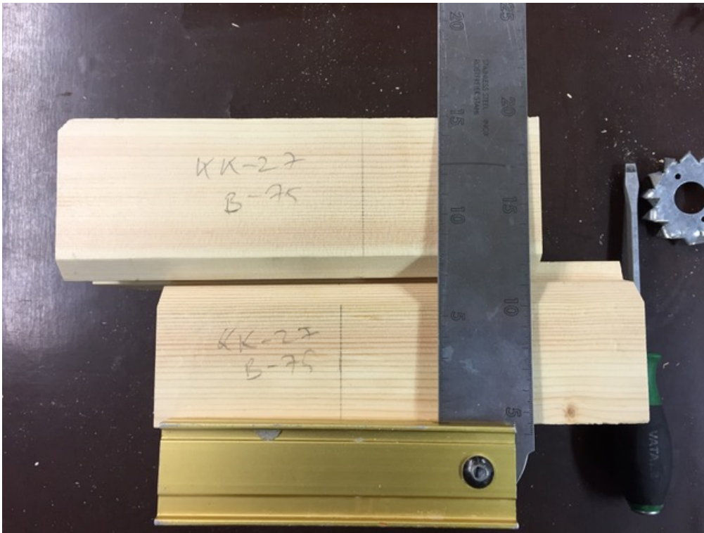
Joonis L5.13. Katsekeha KK27 põhjal näide elementide omavahelisest siirdest katse lõpuks
