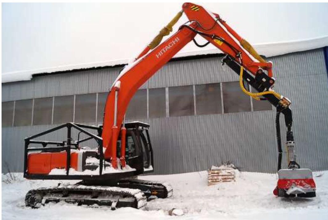
Joonis 2. Ekskavaator Hitachi zx 240 koos Log Max peaga ( www.metsis.com )
