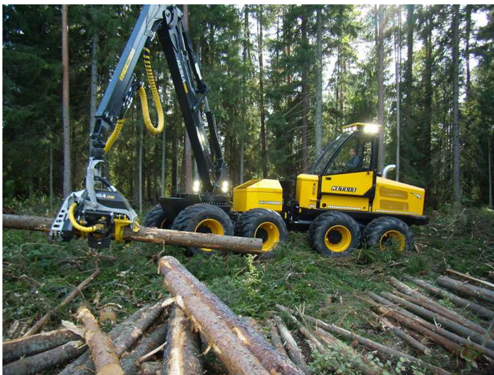
Joonis 1. Harvester Metsis 608H koos Kesla harvesteri peaga (www.metsis.com)
