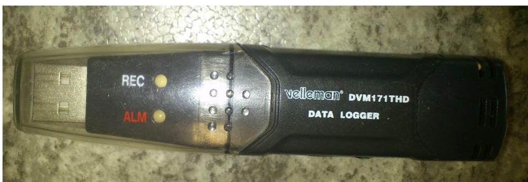
Joonis 2.1. Velleman DVM171THD niiskuse ja temperatuuriandur.
