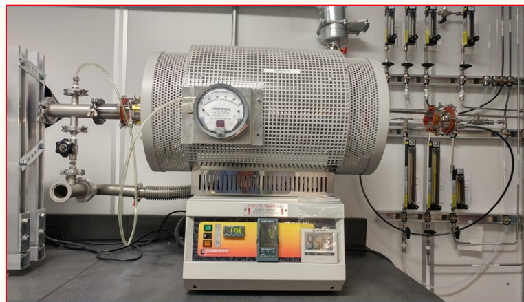
Figure 3-1 : photo du montage expérimental (four à tube Carbolite) utilisé pour la CVD.
