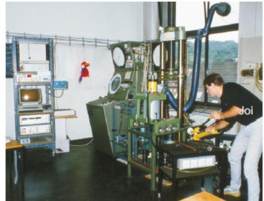
2. Aachener Verformungsapparatur in Betrieb bis etwa 1994, ermöglichte Verformungsversuche bis ca. 450°C und variablen Verformungsraten mit digitaler Datenerfassung durch einen Apple PC.
