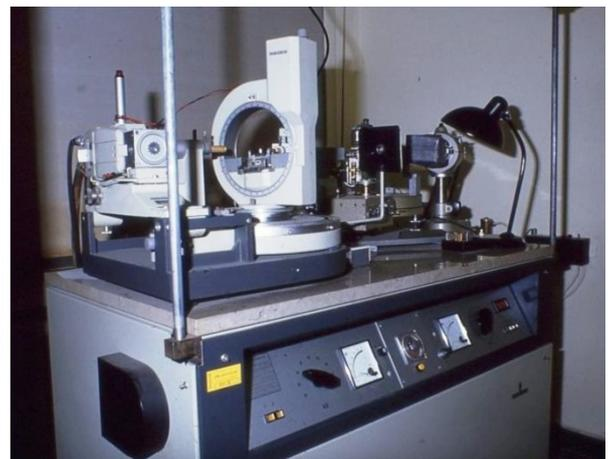
**Links:** Siemens Röntgentexturgoniometer der 1. Generation mit mechanischen Klinkenverstellungen von Pol- und Azimutwinkel montiert auf einem Beugungsgoniometer zur Durchführung von  $\delta/2\delta$ -scans.
