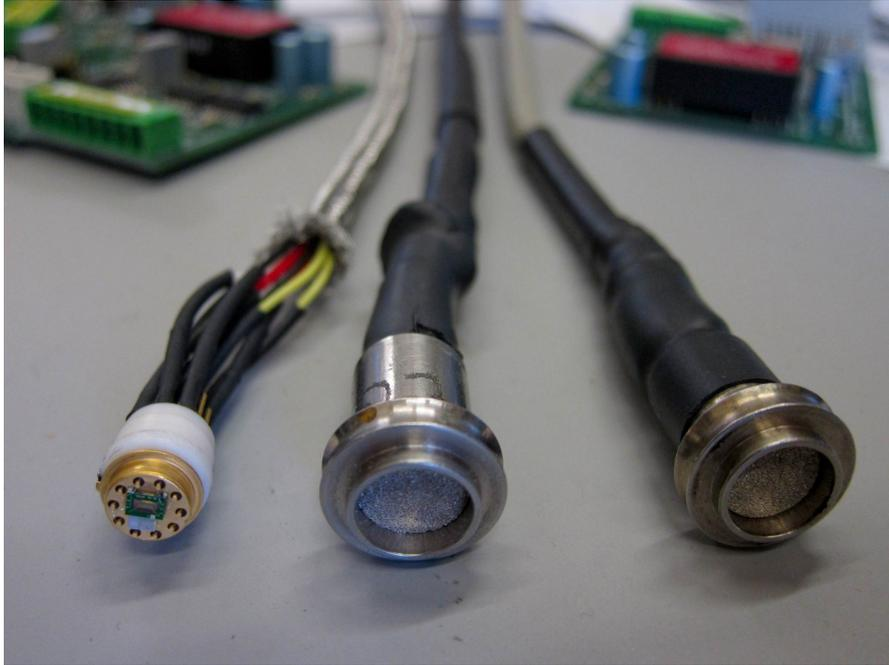
Abbildung 3.6: Von links nach rechts: Sensor auf Sockel, Sensor mit Sintermetallkappe, Sensor mit Sintermetallkappe und Schrumpfschlauch zur Befestigung [Ste11]
