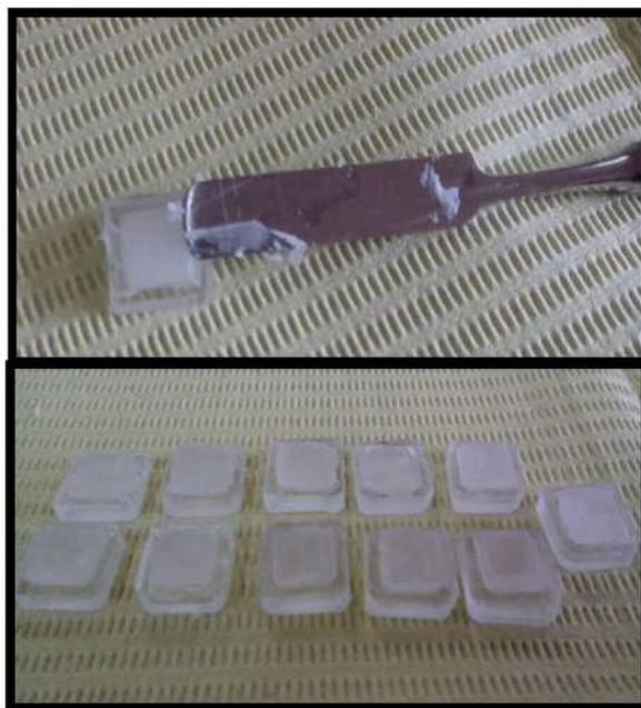
Fig. 3 Colocación de la resina autopolimerizable en moldes de plástico.
