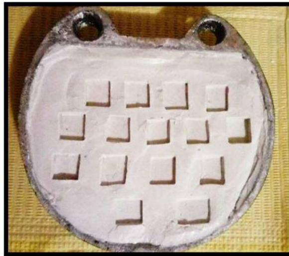
Fig. 6 Descencerado y colocación del separador.
