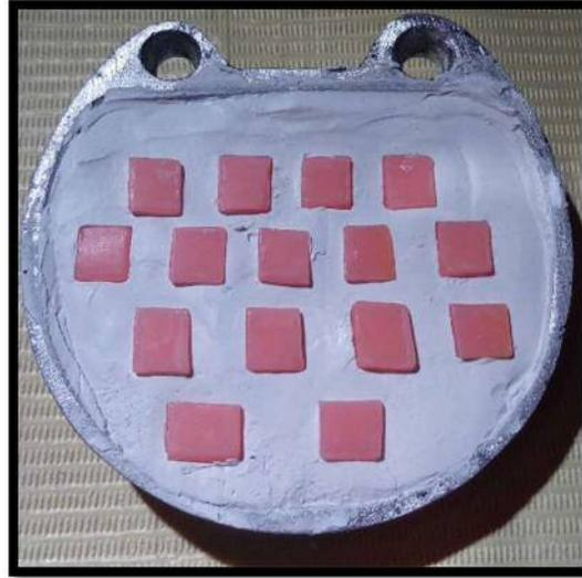
Fig. 5. Colocación de los recuadros de cera dentro de la base de la mufla.
