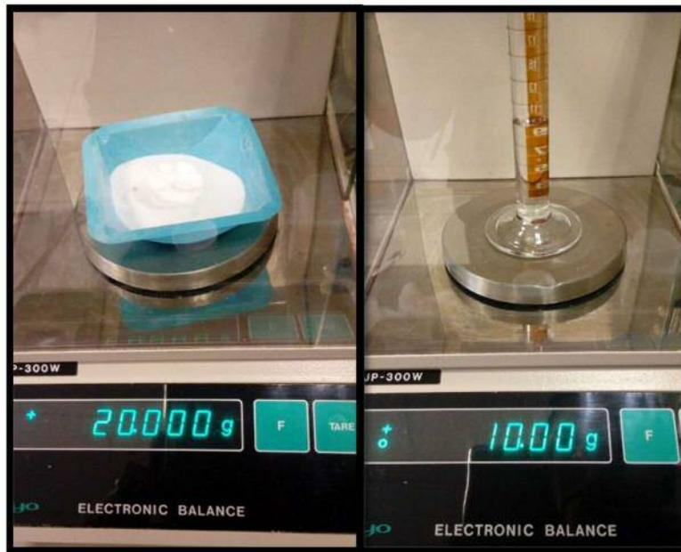
Fig 1. Medición del polvo y líquido de resina autopolimizable siguiendo indicaciones del fabricante.
