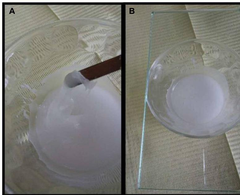
Fig. 2 Preparación del acrílico. (A) Mezcla del polvo y líquido, con ayuda de la espátula. (B) El recipiente es tapado, para evitar la inclusión de aire.
