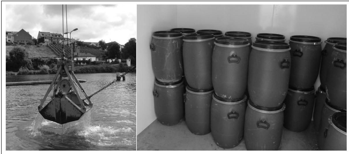
Abbildung 3-15: links: Eingesetzter Van-Veen-Greifer zur Sedimentgewinnung an der Mosel, rechts: Lagerung der Natursedimente im Kühlraum
