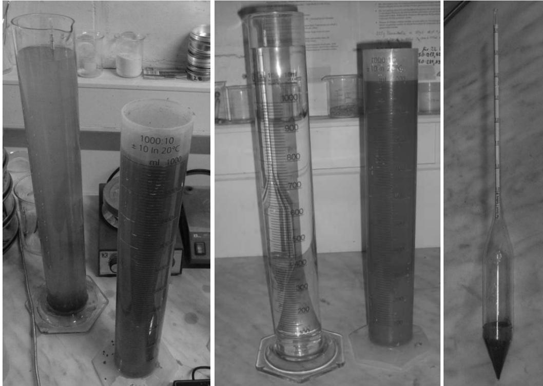
Abbildung 3-16: links und mittig: Zylinder mit vorbereiteter Suspension zur Durchführung der Schlämmanalyse, rechts: Aräometer zur Messung der Dichte  $\rho'$  der hergestellten Suspension
