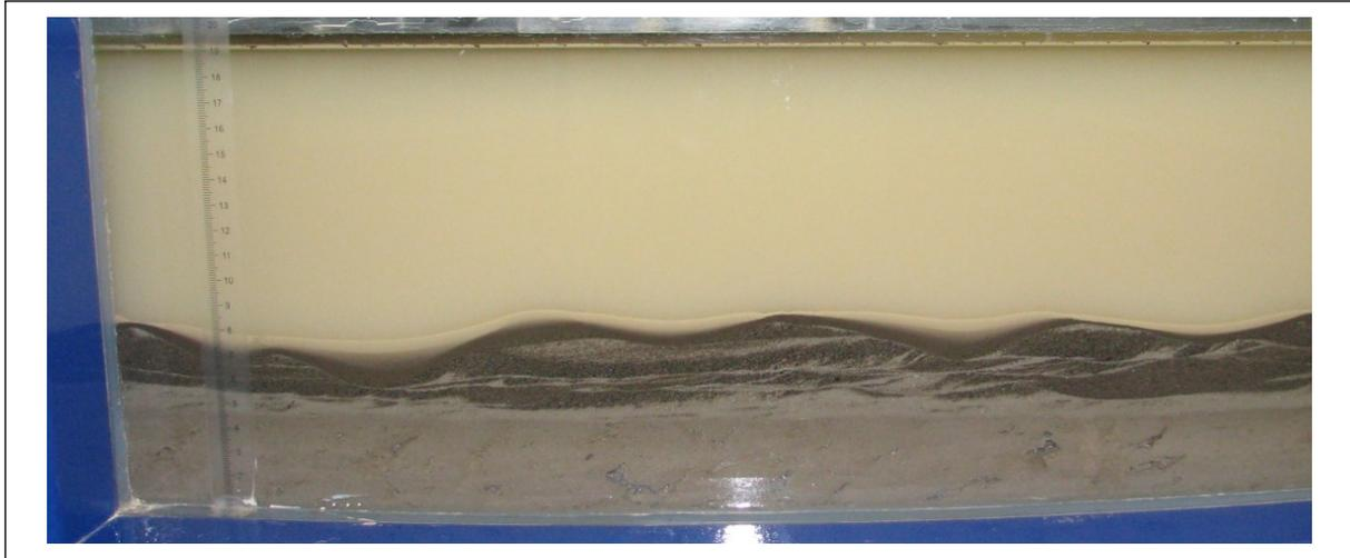
Abbildung 3-13: Darstellung der Entmischung des OECD-Sediments im Verlauf der Vorexperimente im Rahmen der Machbarkeitsstudie nach Abschluss der Erosionsphase
