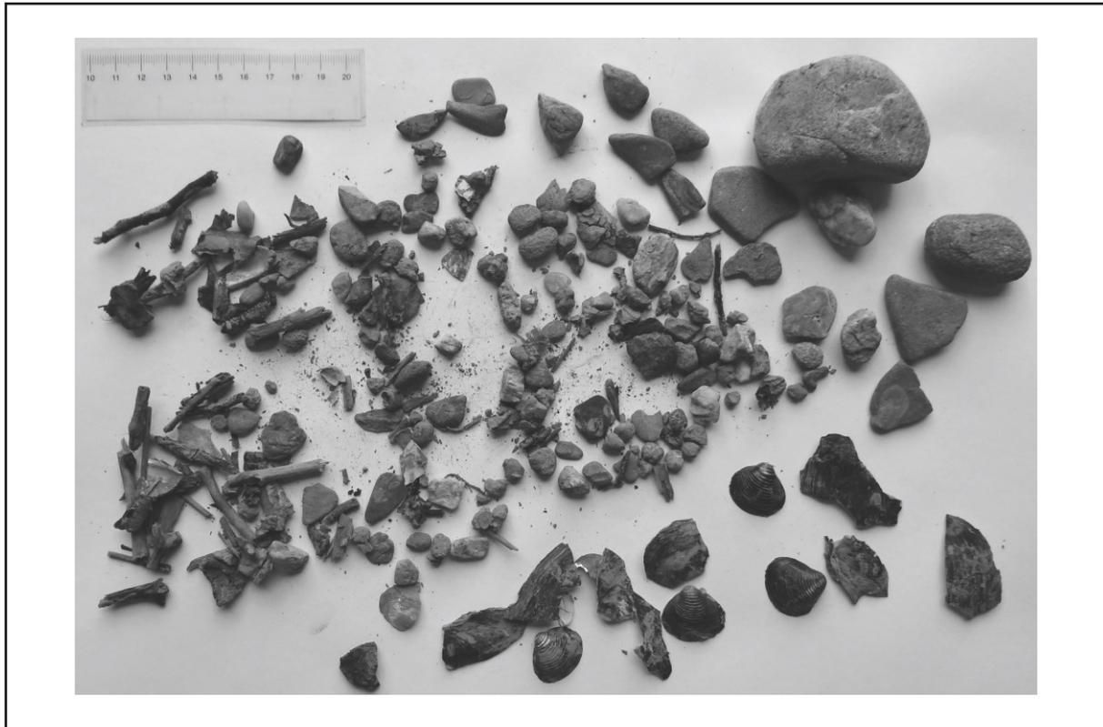
Abbildung 3-18: Siebrückstand für  $d > 6,3$  mm, der nicht ins Kreisgerinne eingebracht wird; hier: Sediment aus dem Rhein
