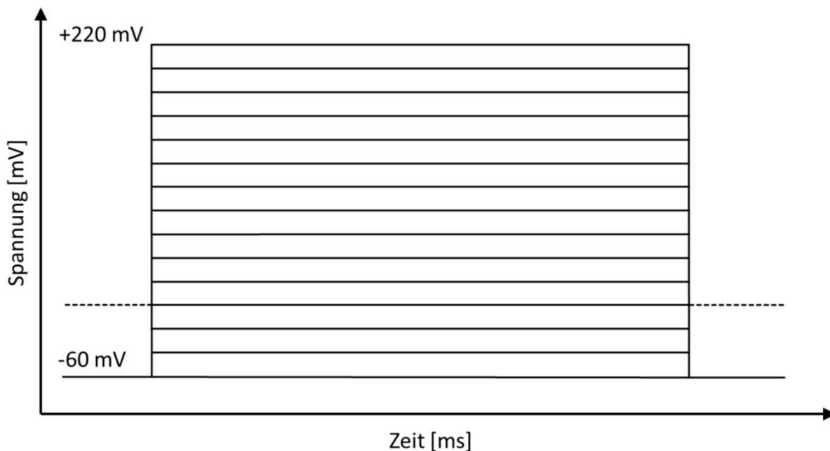
**Abb. 9:** Schematische Darstellung des Spannungsstufenprotokolls 1 (SSP1). Die Amplitudendifferenz zwischen den einzelnen  $50 \text{ ms}$  dauernden Spannungsstufen beträgt  $20 \text{ mV}$ . Die aufeinanderfolgenden Spannungsstufen, beginnend bei  $-60 \text{ mV}$  bis  $+220 \text{ mV}$ , sind der Übersichtlichkeit und Vergleichbarkeit halber übereinander dargestellt. Die gestrichelte Linie stellt ein Haltepotential bei  $0 \text{ mV}$  dar.
