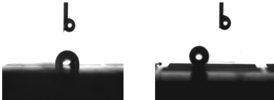
Bild 76: Wassertropfen auf unterschiedlich hydrophoben Oberflächen links: 90° rechts: 172°
