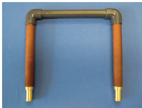
Abbildung 8.2: Zwei beschichtete Rippenrohre vom Typ R1-B2 verbunden mittels eines PVC-Rohrs
