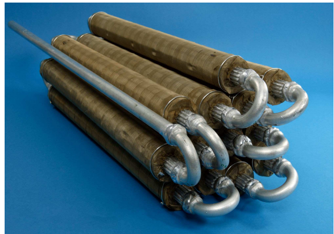
Abbildung 3.2: Foto eines Adsorber-Rippenrohres (links) und des gesamten und befüllten Adsorber-Wärmeübertragers (rechts)
