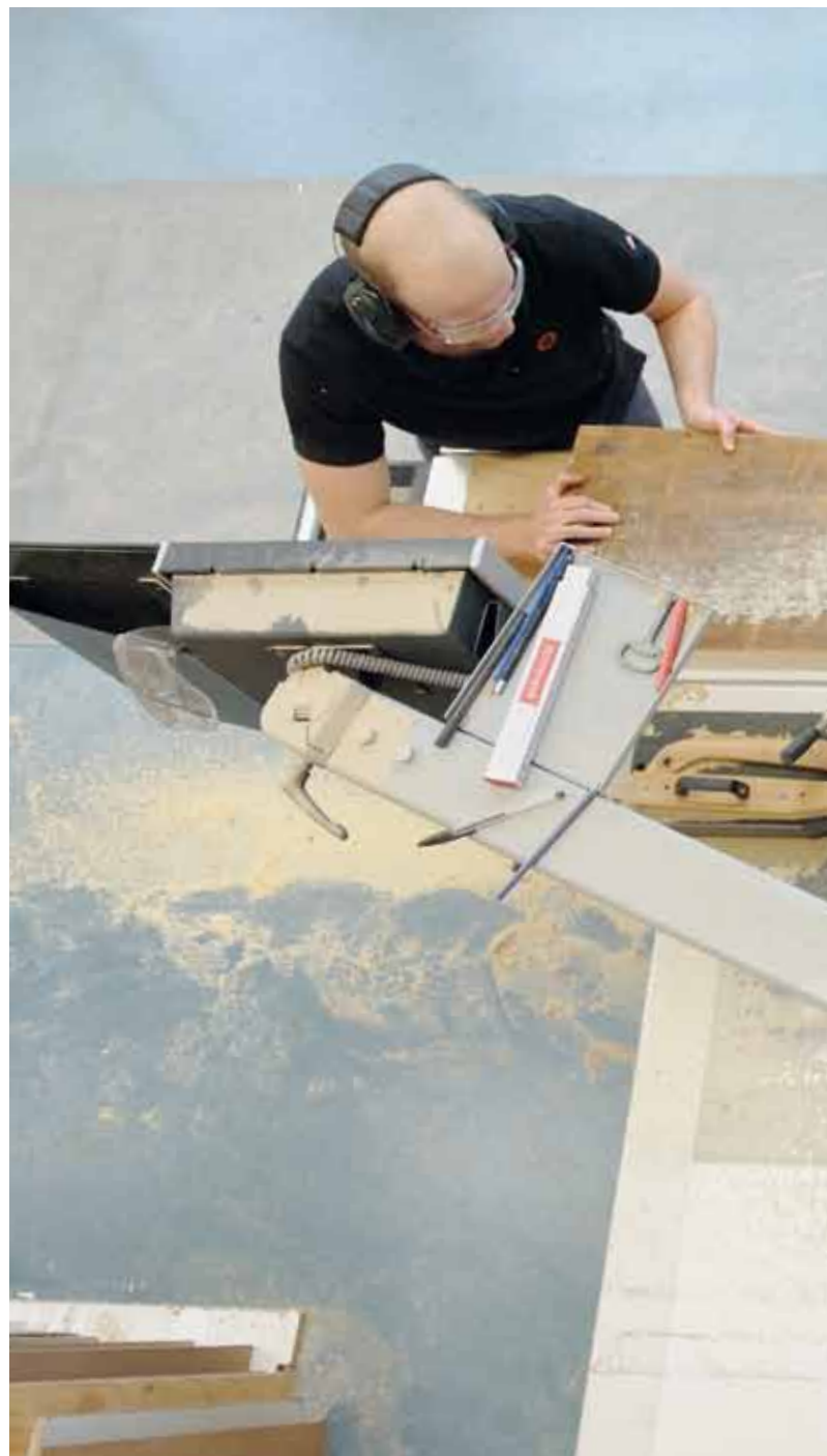
Bild 1: Die Trägerbalken des alten Tivoli in Aachen werden in der Holzwerkstatt für die Wiederverwertung im Counter Entropy House vorbereitet. Foto: Peter Winandy
