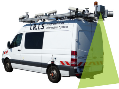
Abb. 1: Das Mobile-Mapping-System I.R.I.S mit dem Laserscanner PPS des Fraunhofer-Instituts für Physikalische Messtechnik, der zentral im hinteren Bereich des Trägerrahmens montiert ist
