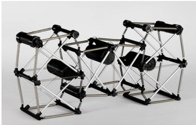
**Abbildung 2.11:** Wurmartiges Lokomotionssystem auf Basis einer Tensegrity Struktur für die Fortbewegung in Rohr- und Schachtsystemen (Forschergruppe Böhm).
