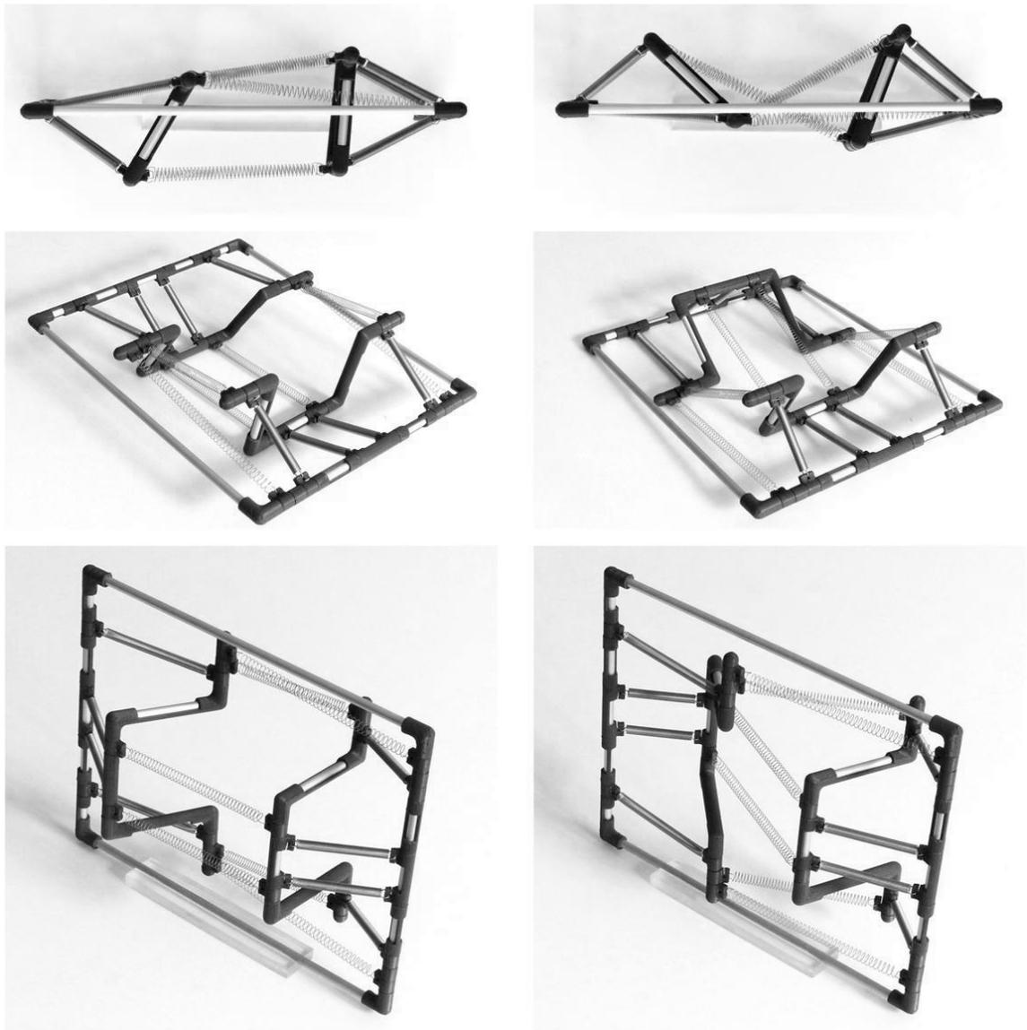
**Abbildung 2.12:** Unterschiedliche stabile Gleichgewichtskonfigurationen einer multistabilen Tensegrity Struktur [Böh16].
