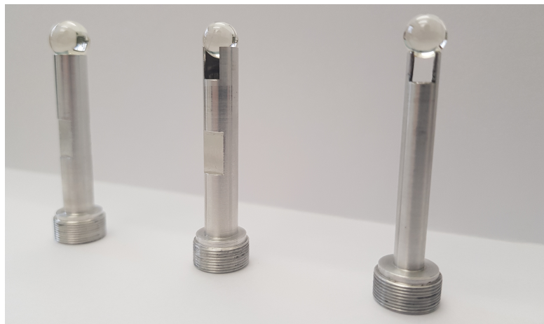
Abb. 4.12: Links: Prinzipdarstellung der Fassung der Kugellinse durch eine stoffschlüssige Klebeverbindung, zusammen mit den von den Interferometern überstrichenen Bereichen. Rechts: Evolutionsstufen der Entwicklung der Kugellinsenfassung mit drei Iterationen.
