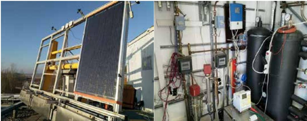
Abbildung 5: PVT-Prüfstand mit „solar tracker“ am ZAE Garching
