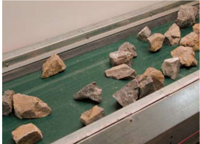
3 Singled limestone particles on a belt conveyor [RWTH-AMR] Vereinzelte Kalksteine auf einem Transportband
