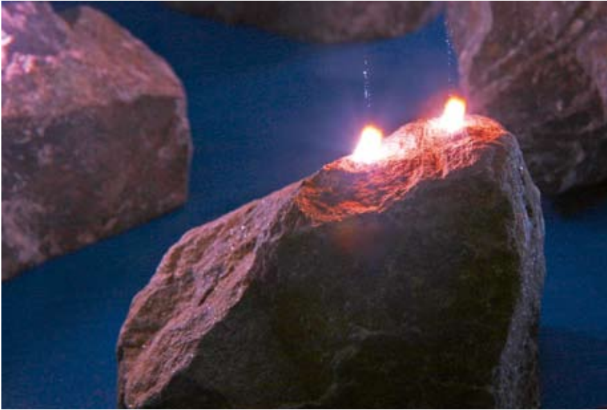
1 Laser-induced plasma on a limestone Laser-induzierte Plasmen auf einem Kalkstein
