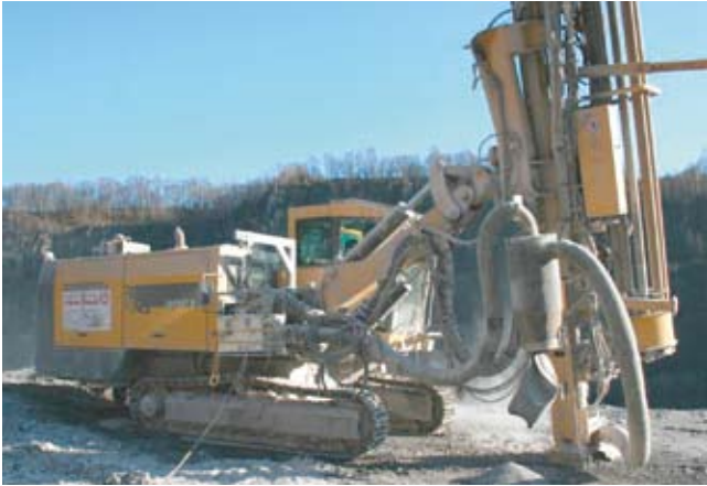
2 Laser module for the dust analysis, ready for operation at the drilling unit Lasermodul für die Staubanalyse einsatzbereit am Bohrergerät montiert
