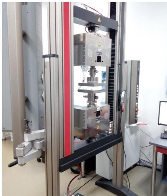
**Figura 3.21.** Máquina ZWICK-ROELL modelo Z050 (PUCP).
