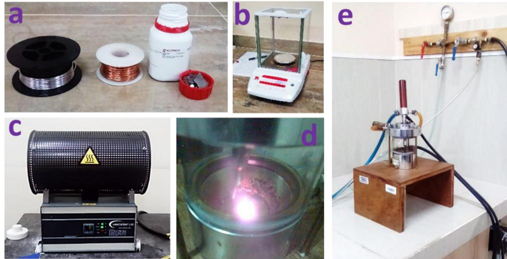
**Figura 3.2.** a) Elementos precursores, b) balanza analítica, c) horno tubular, d) muestra de cuasicristal recién sintetizada y e) horno de arco.
