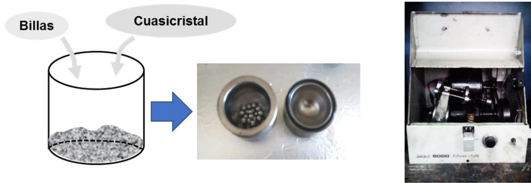
**Figura 3.3.** A la izquierda, esquema de la preparación del contenedor con la muestra cuasicristalina y las billas para la nanoestructuración. A la derecha, molino vibratorio SPEX 8000.
