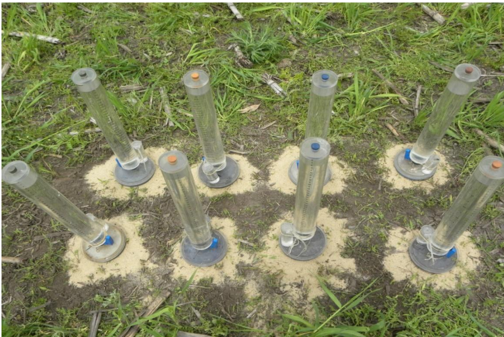
Fotografía 2. Ensayos de infiltración a campo.
