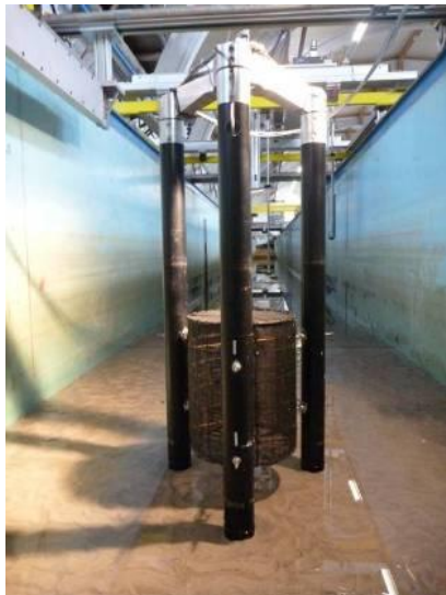
Abbildung 2: Einbau des Zylinderförmigen AKK im Tripile-Fundament (links), Kolkuntersuchungen mittels Messstäbchen unterhalb des AKK (rechts)
