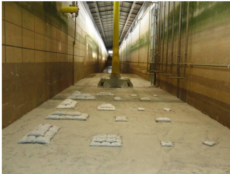
Abbildung 1: Versuchsaufbau der Untersuchung zur Lagestabilität der geotextilen Sandcontainer im GWK im Maßstab 1:10
