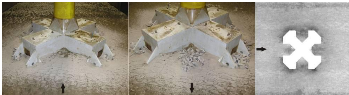
Abbildung 4: Zustand der Kolkentwicklung vor (links) und hinter (Mitte) dem Schaft, Ergebnisplot des Fächerecholots (rechts) nach 5000 Wellen im GWK im Maßstab 1:17 (Wellenangriffsrichtung 45°)
