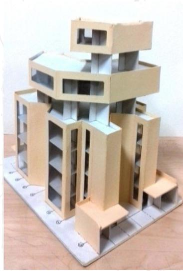
*Imagen 68: El Sistema Estructural / Modelo físico volumétrico + La envolvente (sistema constructivo); (Maqueta – trabajo de Taller en clase). Fuente: Elaborado por Liz Pabón; Diego Erick Álvarez J; Hever Fontalvo. Sem. 2019-1*
