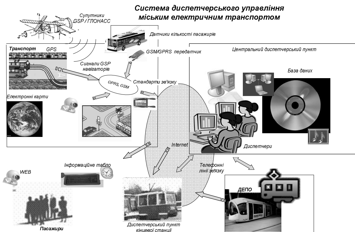
Рисунок 1.2 – Система диспетчерського керування рухом наземного електричного транспорту міста
