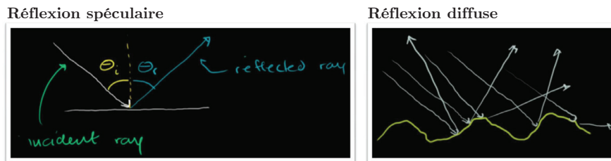
Figure 2.2: Schématisation de la réflexion spéculaire et de la réflexion diffuse Images tirées d'une vidéo de Khan Academy
